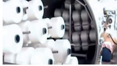
Görsel 6.15: Fiksaj makinesinde çaglıkları makineye yerleştirme
