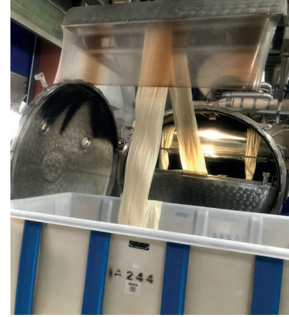
Görsel 4.13: Ağartma işlemi için kumaşı makineye besleme
