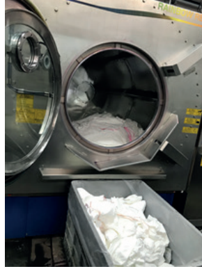
Görsel 6.23: Atmosferik boyama makinesine parça mamulün verilmesi
