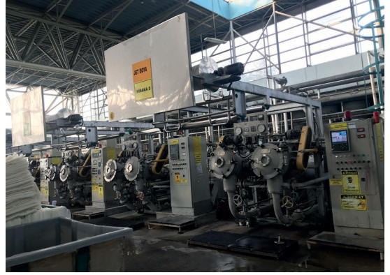
Görsel 3.8: Çektirme yöntemiyle ağartma (HT jet makine)
