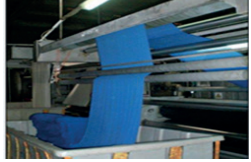
Görsel 7.10: Tüp kesme sonrası sallama kısmı
