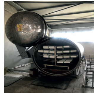
Görsel 6.7: Yıkama öncesi bobin ipliğin fiksajı (termofiksaj makinesi)
