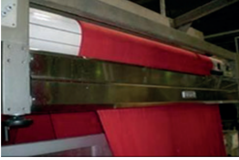
Görsel 7.9: Tüp kumaşı ortalayıcı silindir
