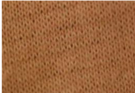
Görsel 1.11: Kumaş (may) dönmesi hatası
