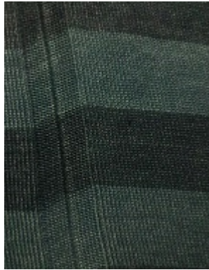
Görsel 1.12: Kumaş (may) dönmesi hatası
