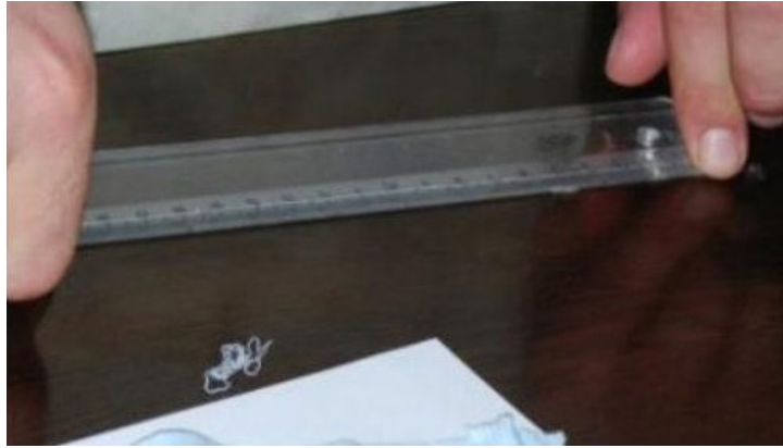
Görsel 3.3: İlmek iplik uzunluğunu ölçme işlemi
