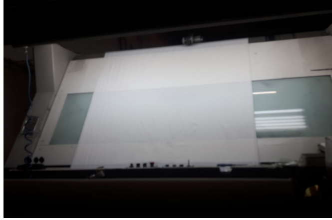
Görsel 3.5: Örme kumaşın kontrol masasında eni ve boyunun kontrolü
