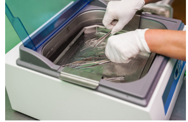
Görsel 2.30.b: Ultrasonik temizleyicinin yakından görüntüsü
