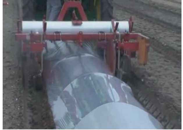
Görsel 1.30: Makine ile örtü malzemelerinin yerleştirilmesi
