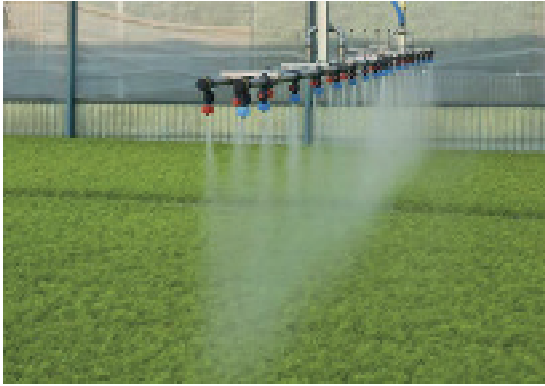
Görsel 2.74: Üstten hareketli yağmurlama sulama sistemi
