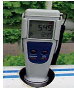
Görsel 2.116: pH-metre ile reaksiyon ölçümü yapma
