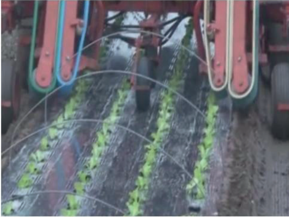
Görsel 1.29: Makine ile iskelet malzemelerinin yerleştirilmesi
