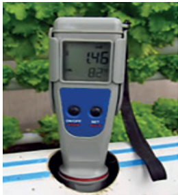
Görsel 2.115: EC ölçer ile tuz ölçümü yapma
