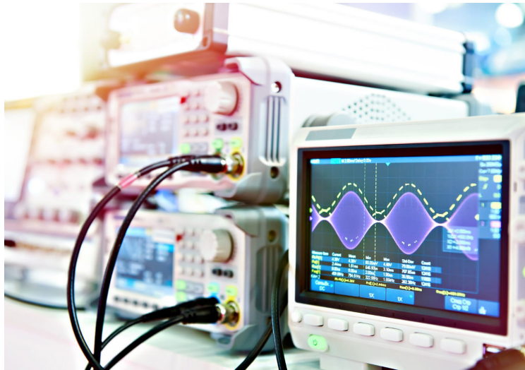
Görsel 4.1 Genlik modülesi sinyal ile bilgi sinyali karşılaştırılması
