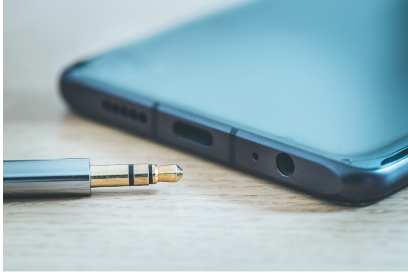
Görsel 3.2:Telefon ile jack bağlantısı
