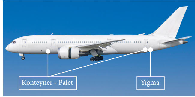
Görsel 2.11. Uçak yük kompartımanları
