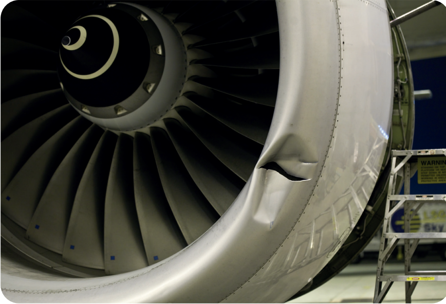
Görsel 2.4: Motor kaportası hasarı
