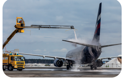
Görsel 2.20: De-icing işlemi
