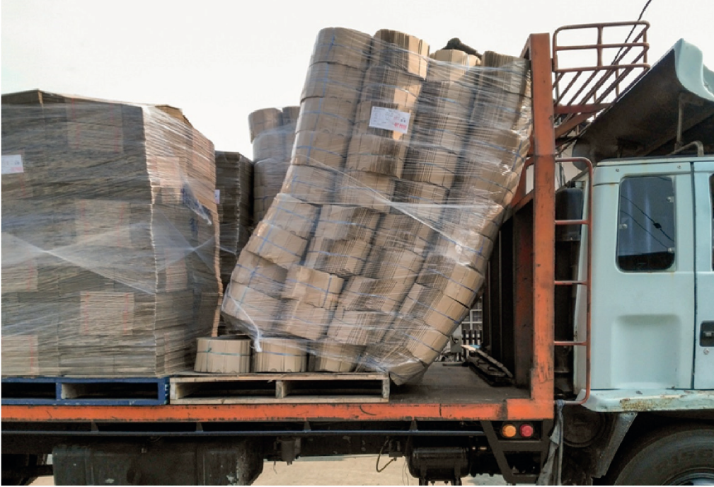
Görsel 3. 1: Nakliye sırasında oluşan hasar
