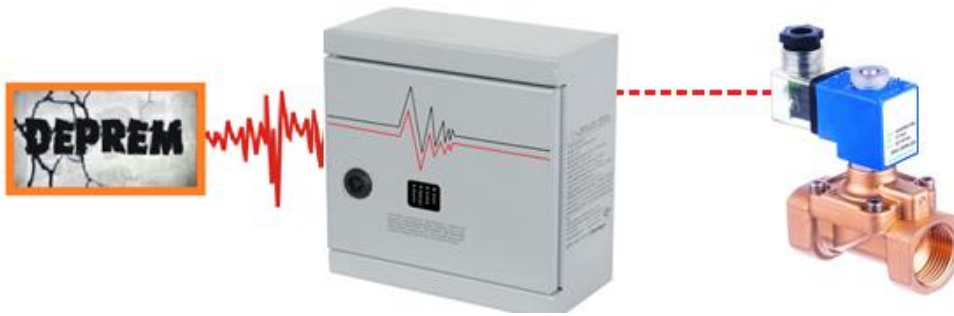
Görsel 3.9: Elektromekanik deprem vanası çalışma prensibi
