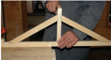
Resim 10.46: Askılı çatı makası alıştırma
