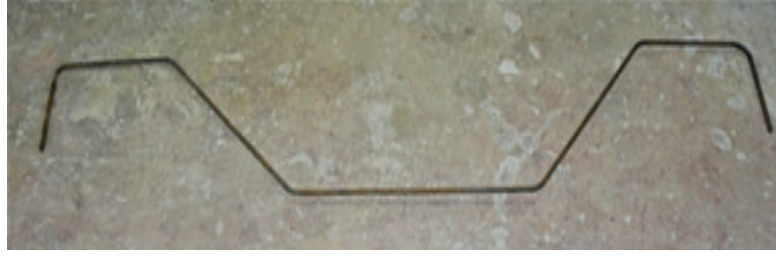
Resim 11.28: Tamamlanmış pilye demir donatısı
