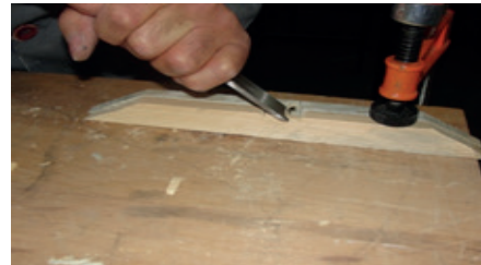
Resim 10.55: Kuşağı aşığı alıştırma
