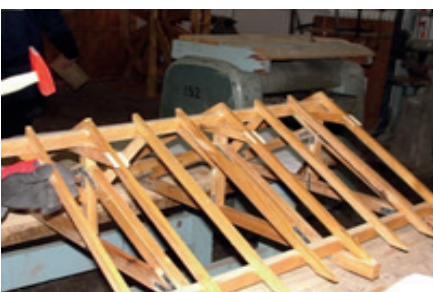
Resim 10.70: Merteklerin ip korunda olması
