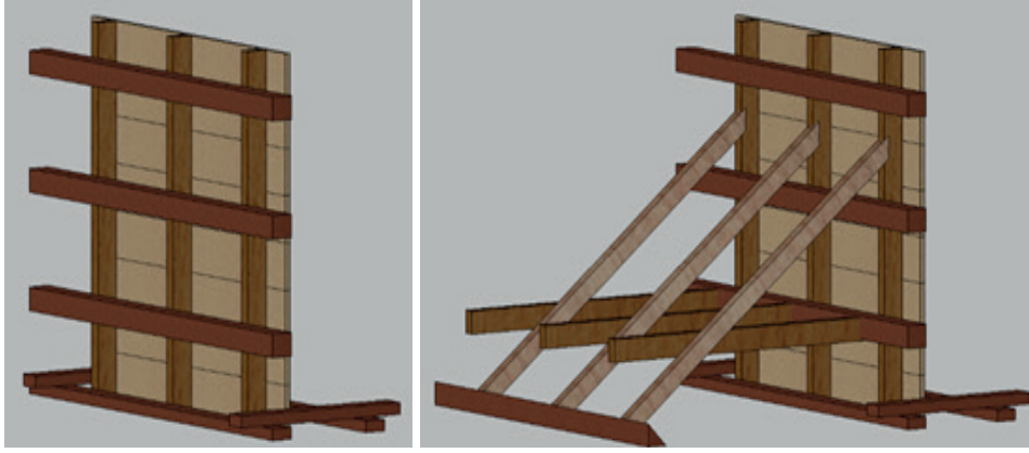
Şekil 3.12: Kalıp yüzey tahtasının şakulüne getirilmesi
