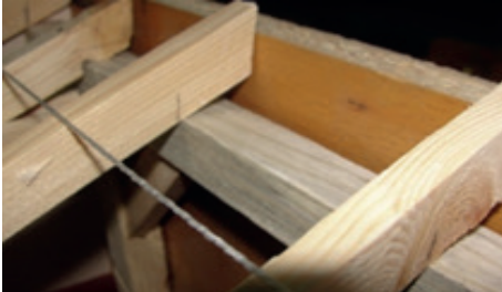
Resim 10.21: Mertek kертmesi yapma
