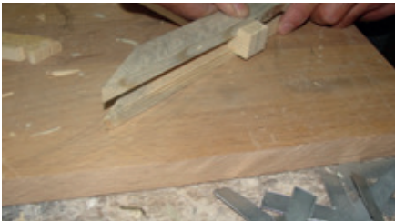
Resim 10.54: Kuşağı merteğe alıştırma
