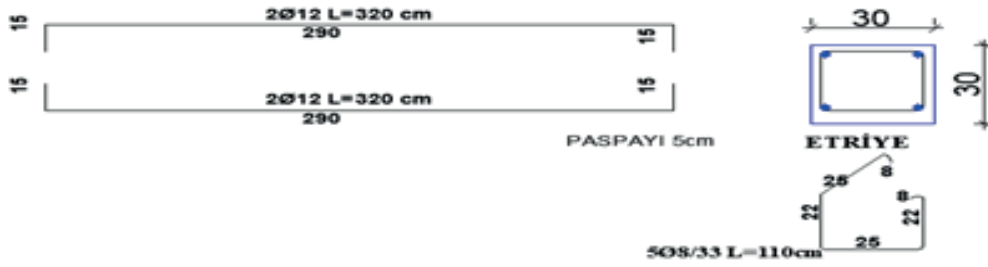
Şekil 14.5: Bağ kirişi 1 donatı açılımı
