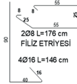
Şekil 14.4: S101 kolon donatı açılımı
