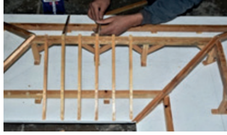
Resim 10.34: Mertekleri yerinde kertme
