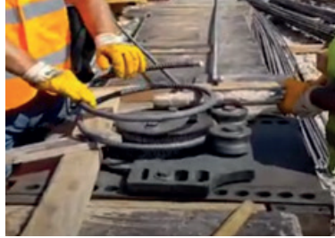
Resim 11.31: Makinede fret yapımı
