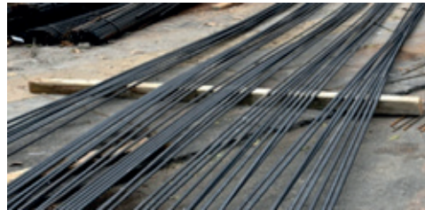
Resim 11.18: Farklı çaplarda nervürlü betonarme demiri
