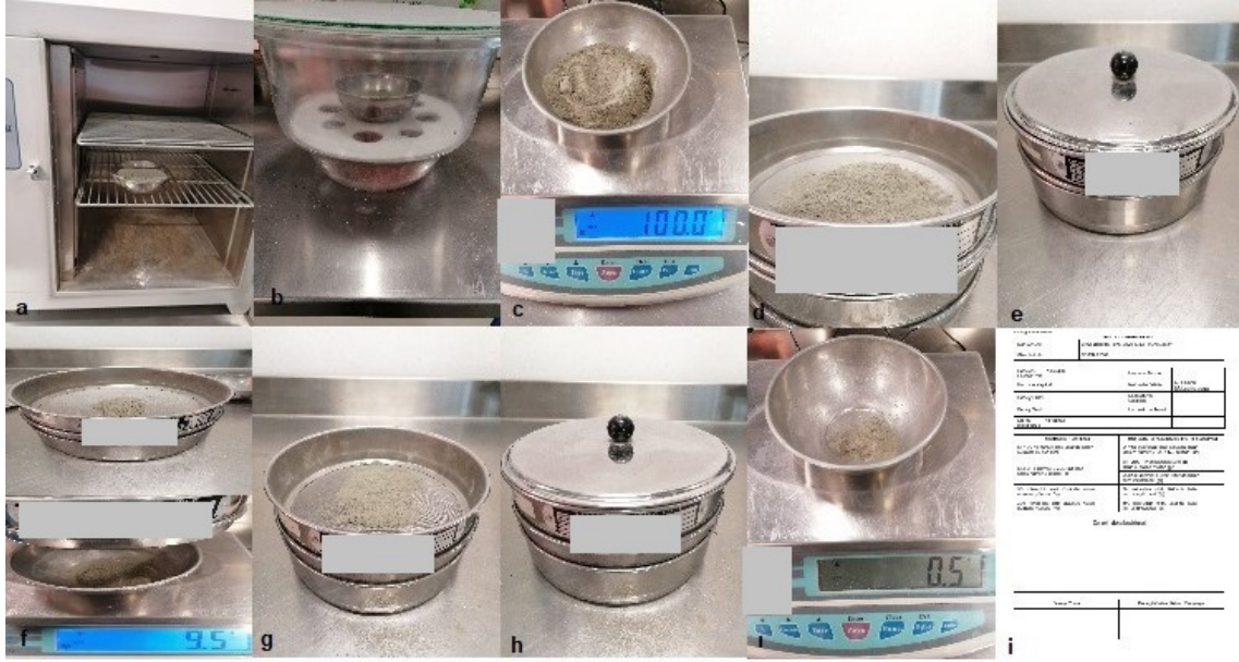
Görsel 15.4: Çimentolarda tane büyüklüğü tayini deneyi (Ele eleme yöntemi)
