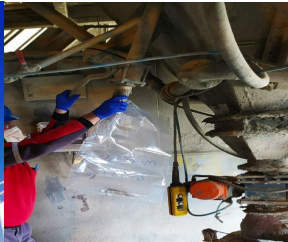
Görsel 10.22: Klappenin açılarak çimento numunesi alınması
