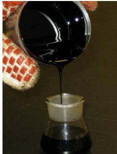
Görsel 6.2: Bitüm numunesinin piknometreye dökülmesi
