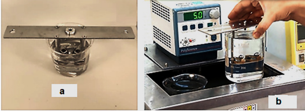
Görsel 6.11: Deney düzeneğinin hazırlanması ve banyo sıvısına yerleştirilmesi
