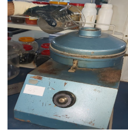
Görsel 8.10: d) Çalışan santrifüje trikloretilenin dökülmesi
