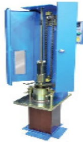
Görsel 7.8: Sıkıştırma tokmağı, tabanı ve tutucu (Otomatik Marshall kompaktör aleti)
