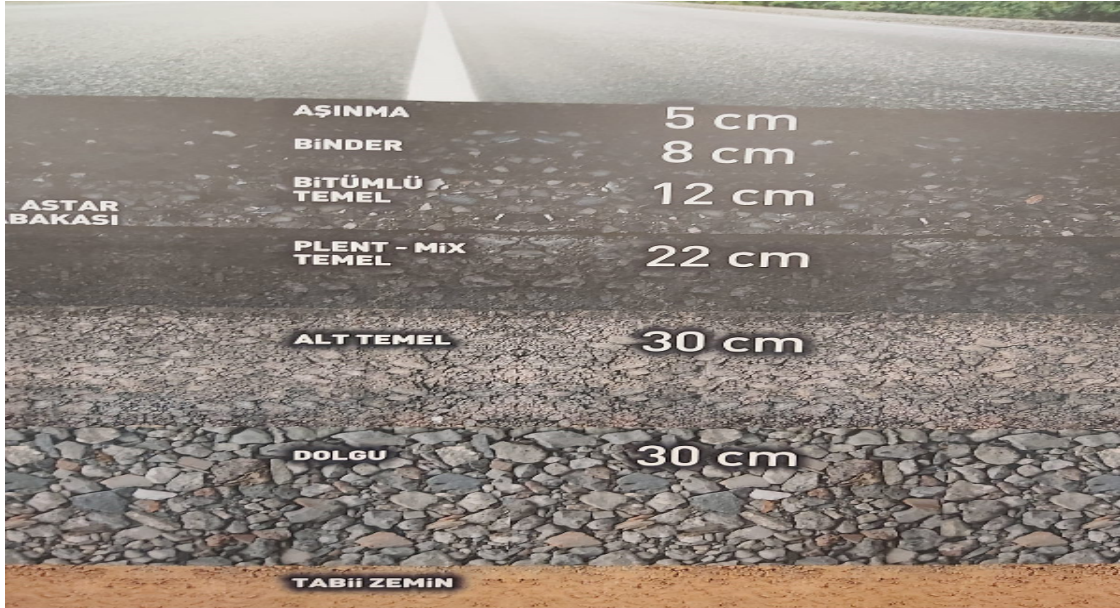
Görsel 7.1: Yol güzergâhını oluşturan tabakalar
