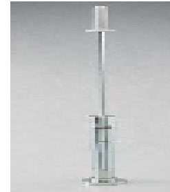
Görsel 7.8: Sıkıştırma tokmağı, tabanı ve tutucu (Otomatik Marshall kompaktör aleti)
