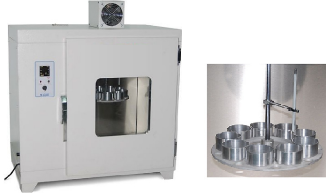
Görsel 6.21: İnce film hâlinde ısıtma etüvü ve taşıyıcı rafı
