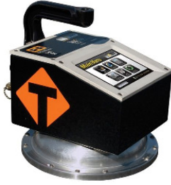
Görsel 8.2: Elektromanyetik yoğunluk ölçme cihazı
