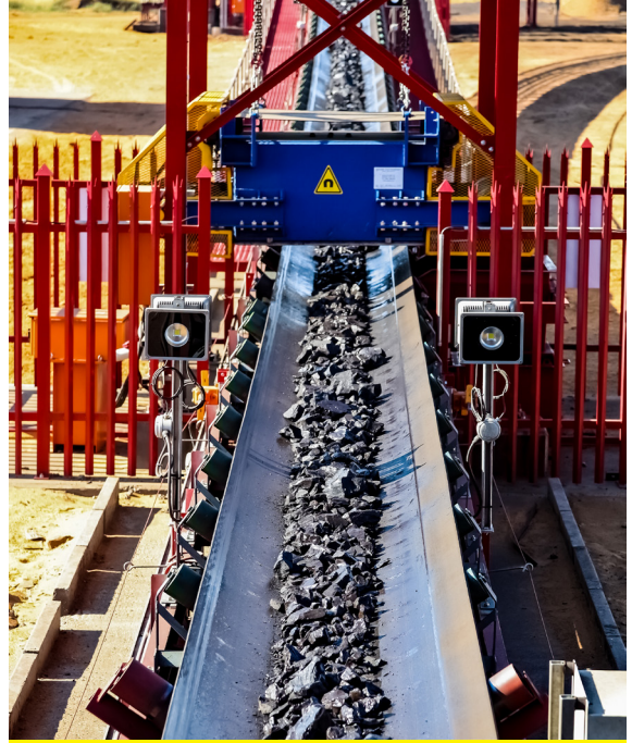
Görsel 4.21: Konveyör bant sistemi ile cevher nakli
