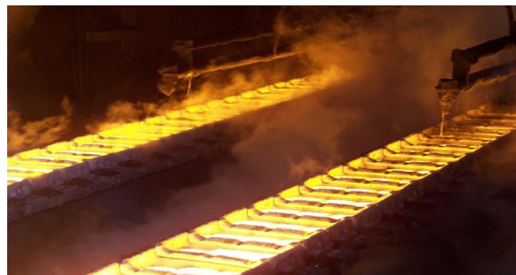
Görsel 7.11: Kalıplardaki pike duşlama suyunun püskürtülmesi
