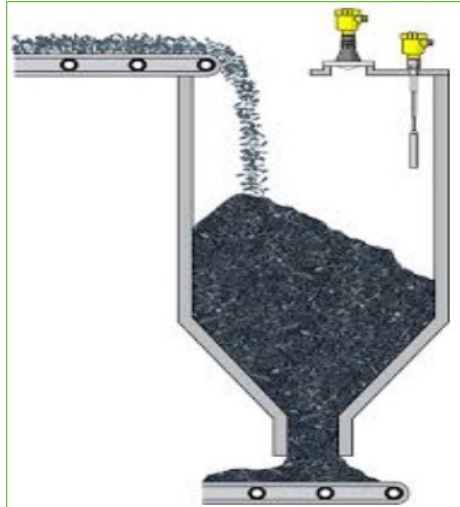
Görsel 1.24: Kömür silosu
