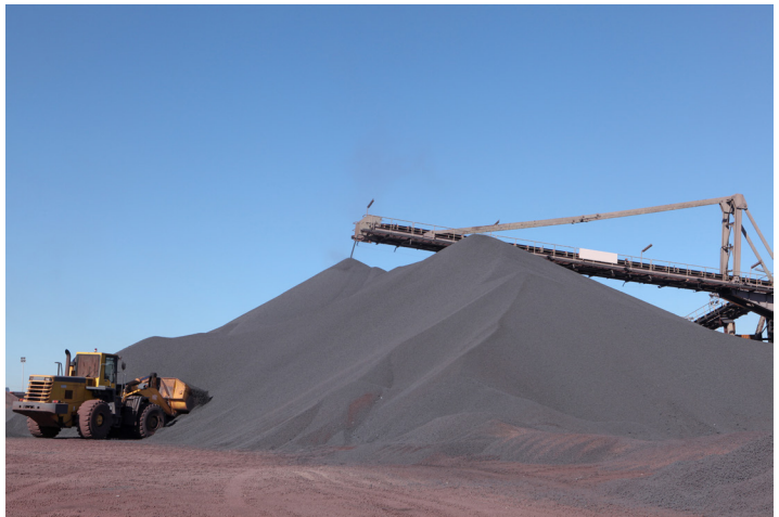
Görsel 4.14: Cevherin konveyör bant sistemi ile yığınlar halinde stoklanması
