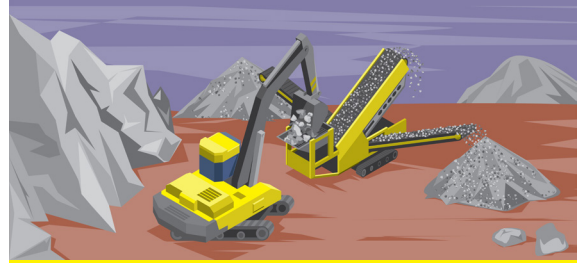
Görsel 4.19: Cevherin kırılması ve tane boyutlarına ayrılması
