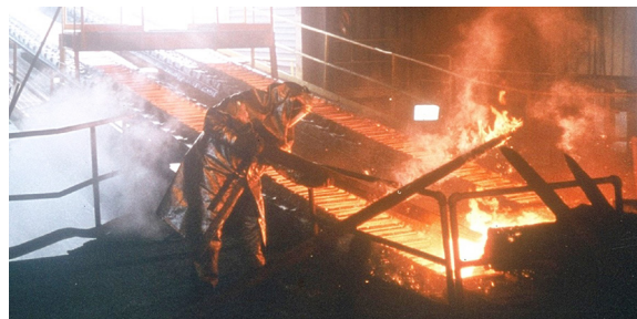
Görsel 7.10: Kalıplardaki pikin söndürme sistemine ilerlemesi
