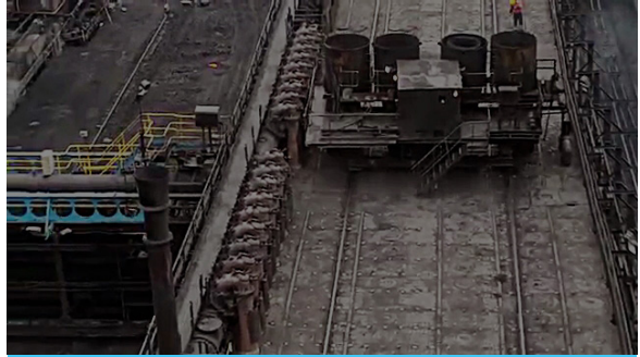
Görsel 3.10: Bataryalar üzerinde raylar üzerinde hareket eden şarj arabası
