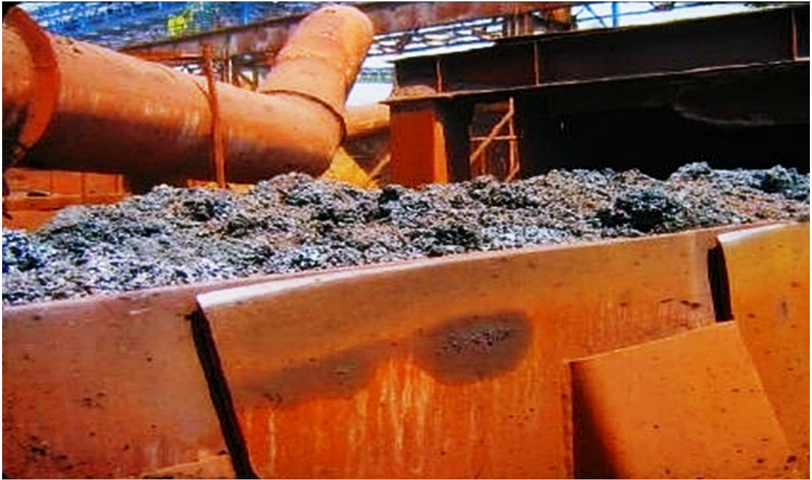
Görsel 5.11: Kırılan ve soğutulan sinterin soğuk eleklerle sevk edilmesi
