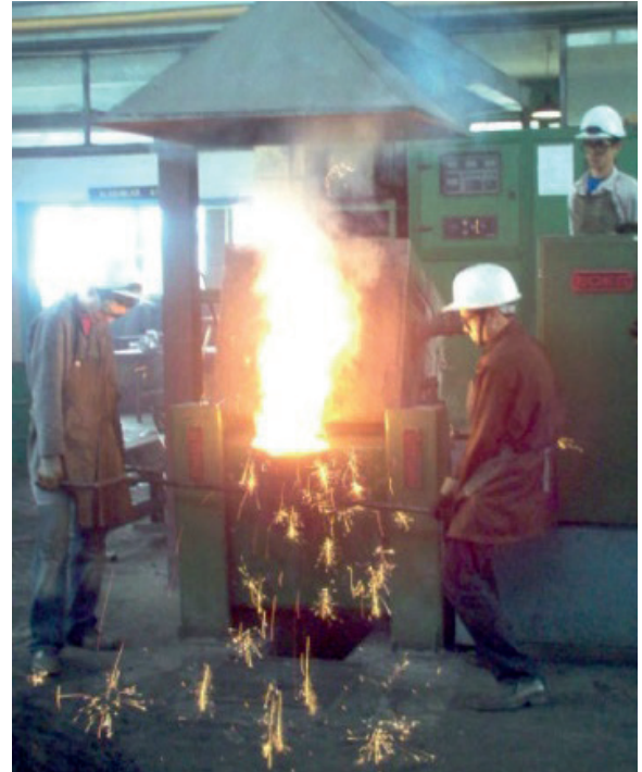
Görsel 8.7: Ocakta ergitilmiş metalin taşıma potasına alınması
