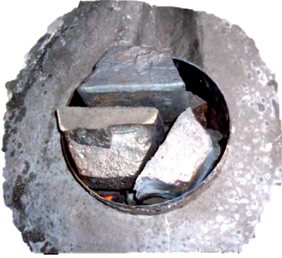
Görsel 8.6: Ocak potasına katı metali yüklenmesi
