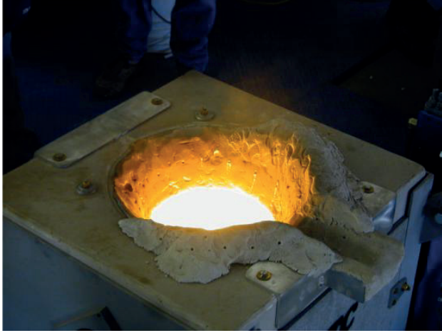
Görsel 8.4: Endüksiyon ocağında ergitme
