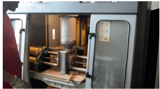
Görsel 5.8: Maça sandığına karbondioksit gazı basılması
