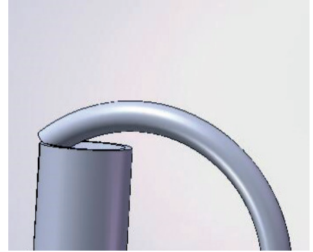
Görsel 6.12: Piston modeli ve boynuz yolluk uygulaması
