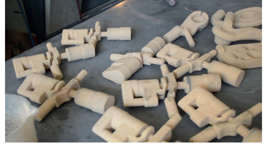
Görsel 5.10: Maça yapma makinesinde soğuk kutu yöntemi ile yapılmış maçalar
