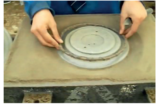
Görsel 6.3: Çevirme maçaya uygun iskelet hazırlama
