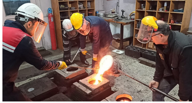
Görsel 7.4: El taşıma potası ile kalıplara döküm
