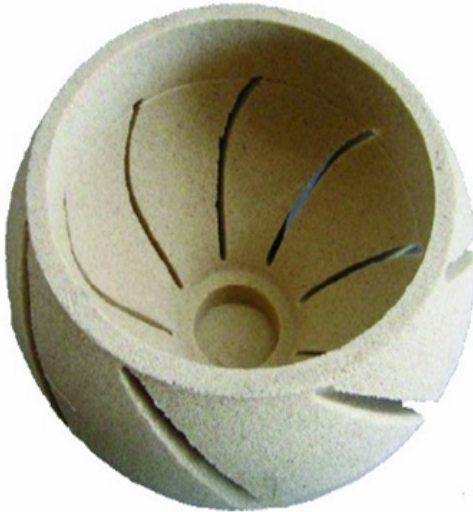
Görsel 5.9: Soğuk kutu yöntemiyle yapılmış maça
