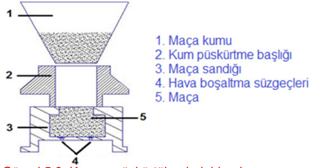
Görsel 5.8: Kumun püskürtülerek doldurulması
