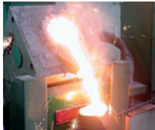
Görsel 8.17: Endüksiyon ocağından sıvı metalin alınması
