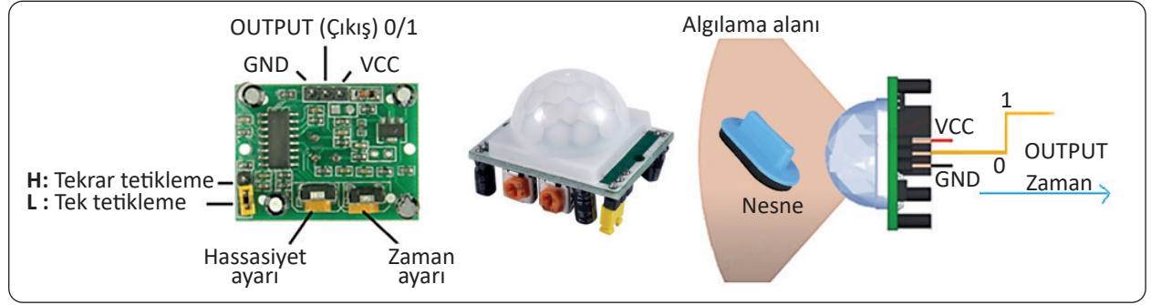
Şekil 2.51: HC-SR502 hareket algılama sensörünün görüntü ve pin bağlantı şeması
