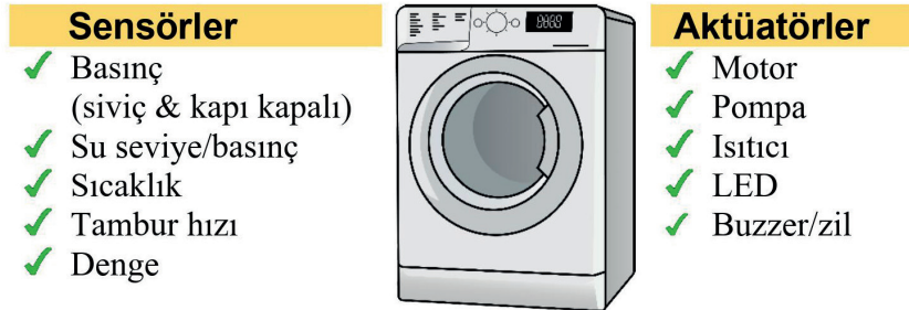
Şekil 1.18: Otomatik çamaşır makinesinde kullanılan sensör ve aktüatörler (çıkış elemanı)
