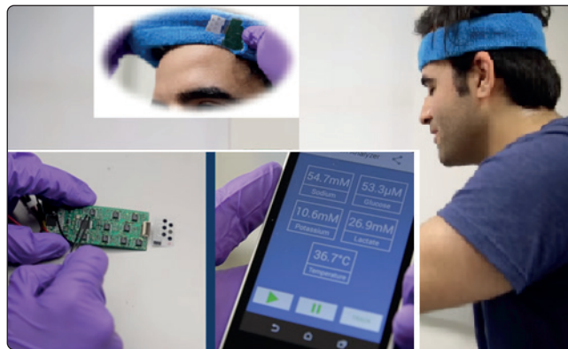
Fotoğraf 1.5: Giyilebilir ter ölçen yamalar
