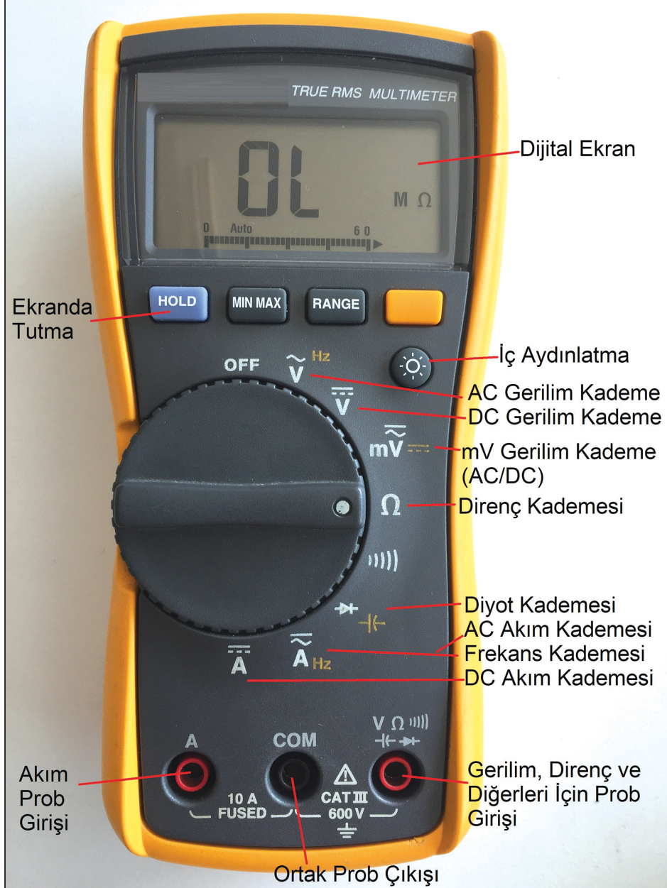
Görsel 1.34: Multimetrenin yapısı
