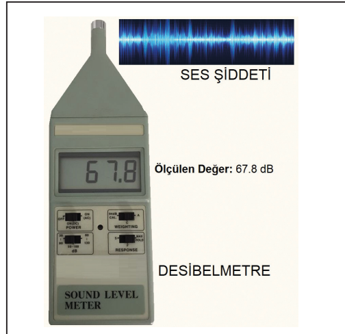
Görsel 1.16: Desibelmetre ile ses şiddetinin ölçülmesi
