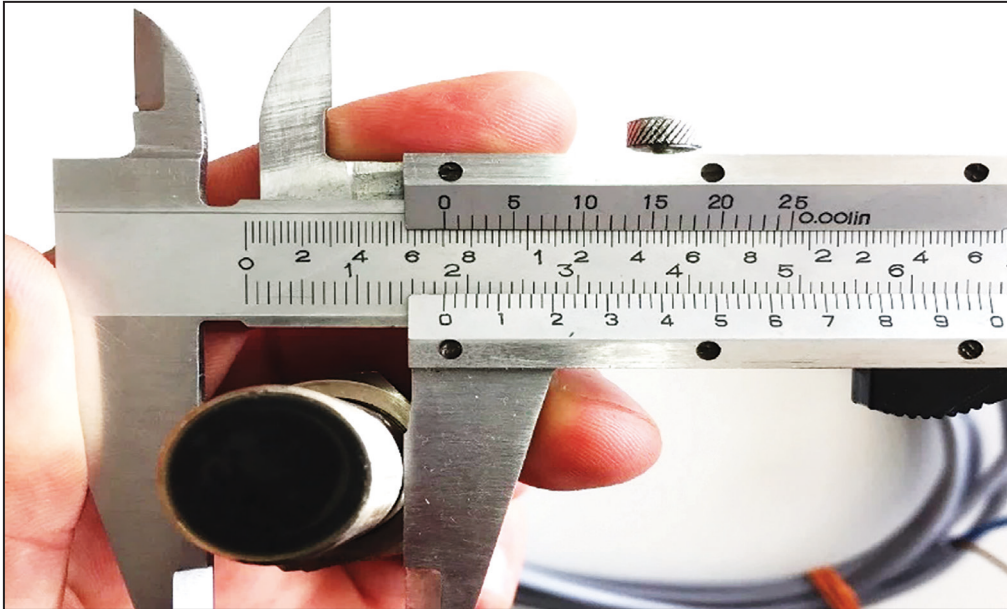
Görsel 1.9: Kumpas ile sensör çapı ölçümü
