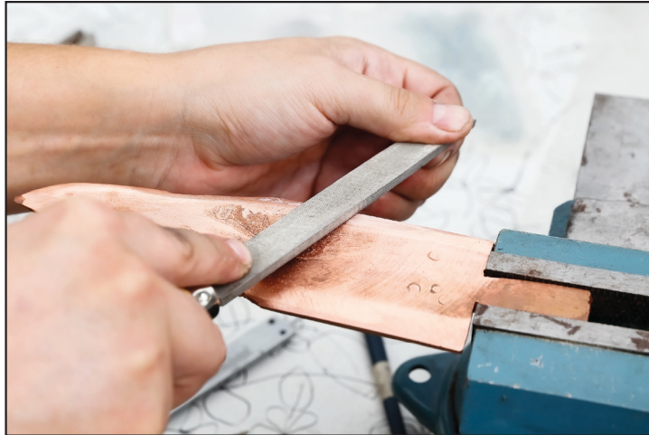
Görsel 3.12: Mengene üzerindeki parçanın eğelenmesi işlemi
