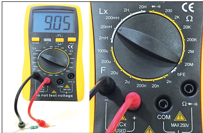
Görsel 4.23: LCRmetre ile endüktans ölçümü
