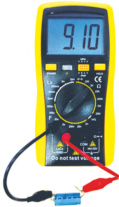
Görsel 4.20: LCRmetre ile kapasite ölçümü
