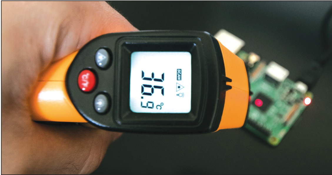
Görsel 1.18: Kızılötesi termometre ile devrede sıcaklık ölçümü
