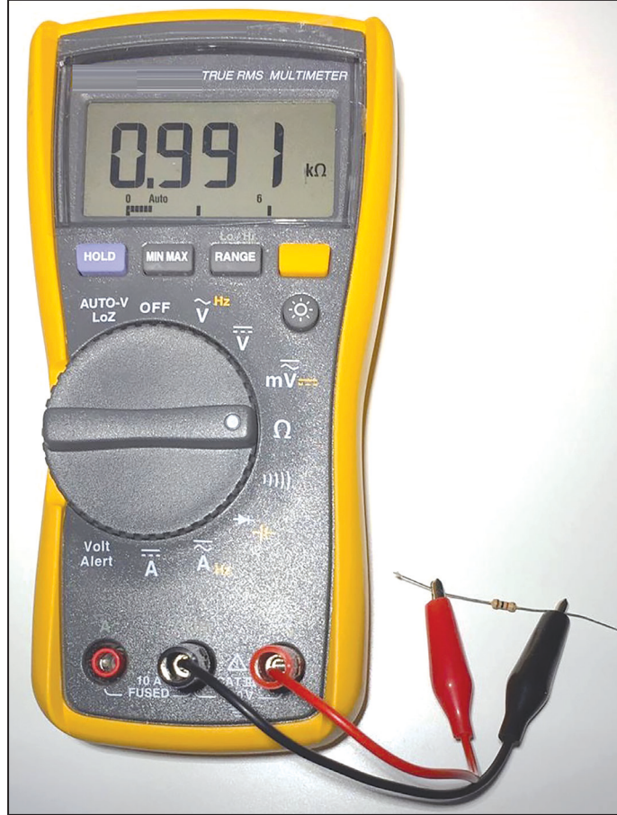
Görsel 4.11: Multimetre ile direnç ölçme işlemi
