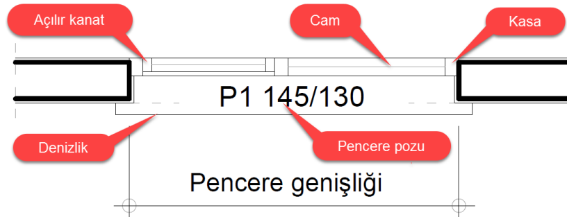
Şekil 5.38: Planda pencere çizimi
