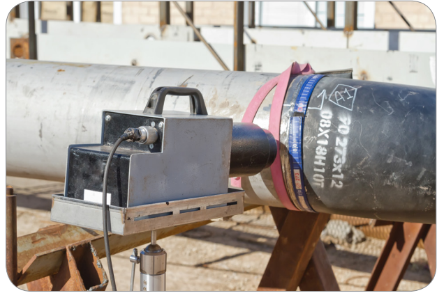
Görsel 3.27: Radyografi test cihazı ile kaynak muayenesi
