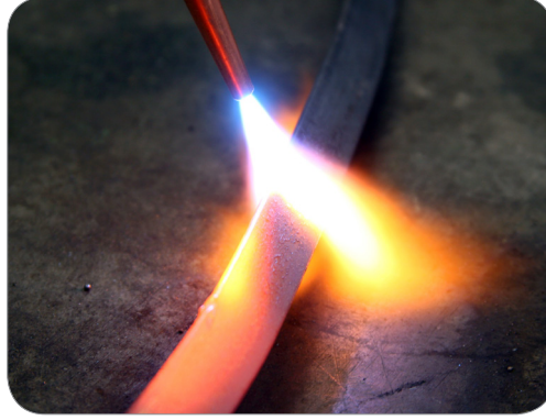
Görsel 1.18: Parçanın alevle ısıtılması
