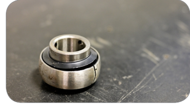
Görsel 5.28: Çatlamış bir rulman
