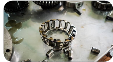
Görsel 5.29: Kafes hasarı
