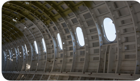
Görsel 1.29: Uçak gövdesi, frame ve stringer yapılar
