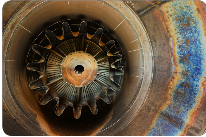
Görsel 2.1: Jet motoru üzerindeki korozyon
