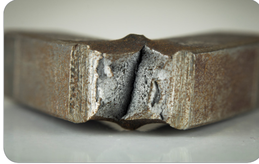
Görsel 1.9: Yeterli süneklığe sahip olmayan malzemenin kırılması
