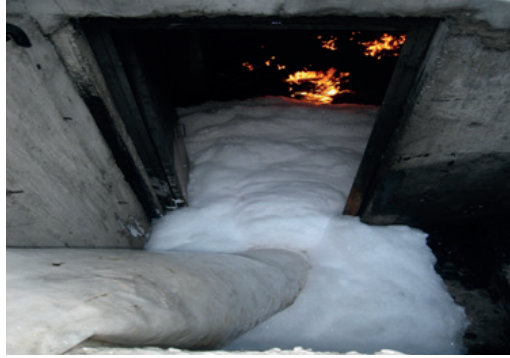
Görsel 2.32: Yüksek genleşmeli köpük uygulaması
