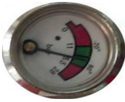
Görsel 2.40: Manometre ibresi yeşil bölge üzerinde olmalıdır.
