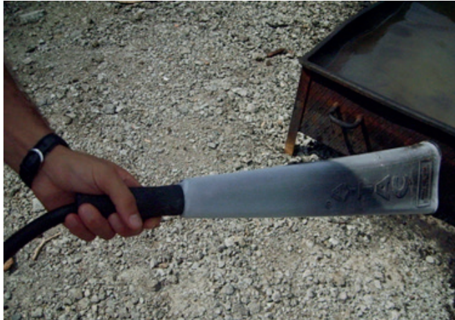
Görsel 2.44: CO 2 cihazının boşaltma borusunun doğru tutulması
