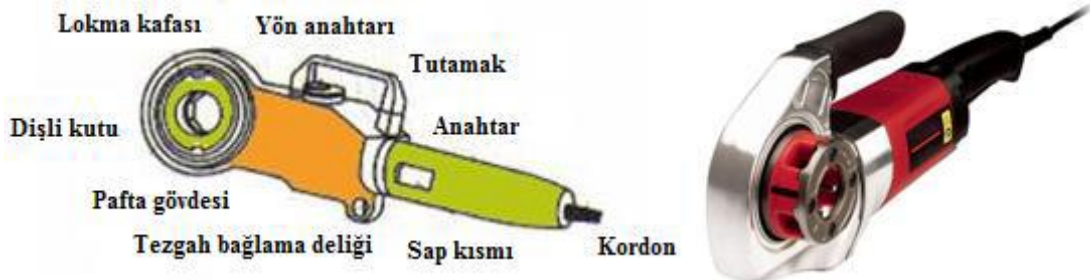
Görsel 4.13: Elektrikli el boru paftası
