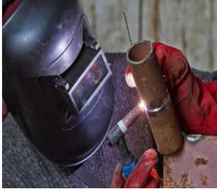
Görsel 13.18: TİG boru kaynağında çeşitli kaynak pozisyonları
