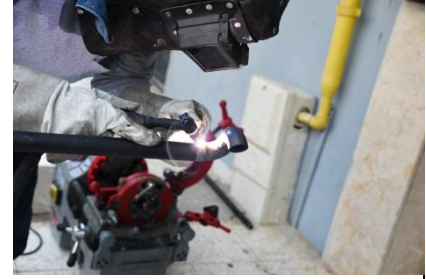
Görsel 13.18: TİG boru kaynağında çeşitli kaynak pozisyonları
