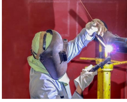
Görsel 13.18: TİG boru kaynağında çeşitli kaynak pozisyonları
