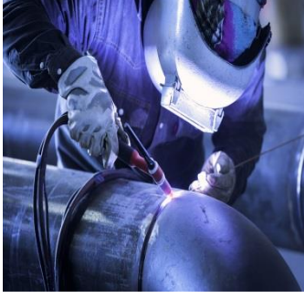
Görsel 13.18: TİG boru kaynağında çeşitli kaynak pozisyonları
