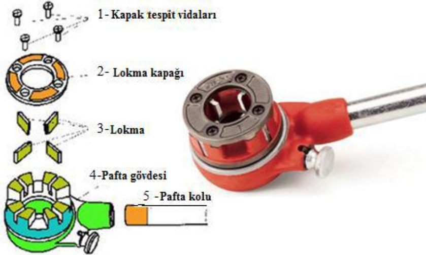
Görsel 4.12: Sabit lokmalı cırcırlı boru paftası
