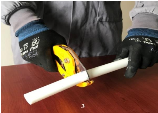
Görsel 5.4: Polipropilen boru kesme aşamaları
