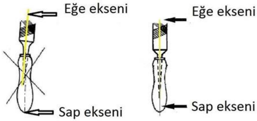
Görsel 3.6: Eğelere sap takma yöntemleri
