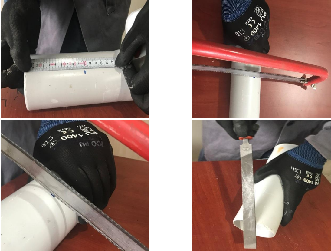
Görsel 5.16: PVC boru kesme ve pah kırma aşamaları
