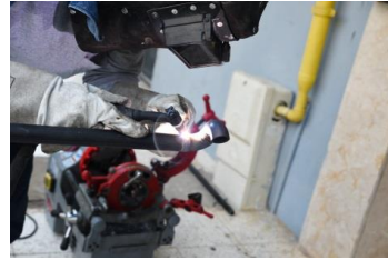
Görsel 13.18: TİG boru kaynağında çeşitli kaynak pozisyonları
