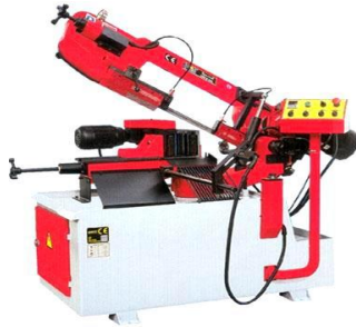
Görsel 2.31: Hidrolik testere makinesi
