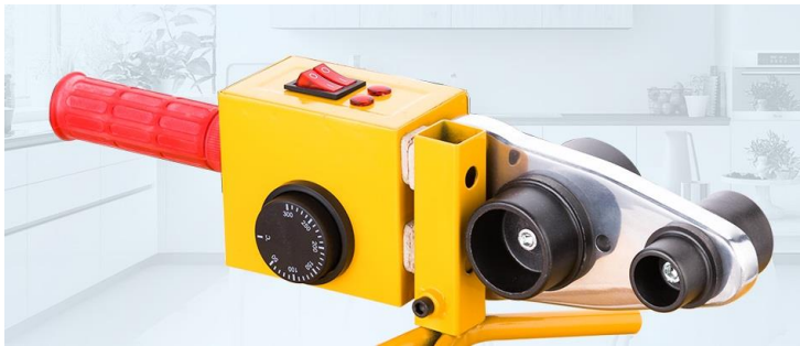
Görsel 5.6:Plastik boru kaynak makinesi
