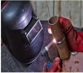
Görsel 13.18: TİG boru kaynağında çeşitli kaynak pozisyonları
