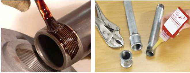
Görsel 4.23:Sıvı conta sürülmesi
