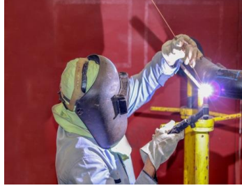
Görsel 13.18: TİG boru kaynağında çeşitli kaynak pozisyonları
