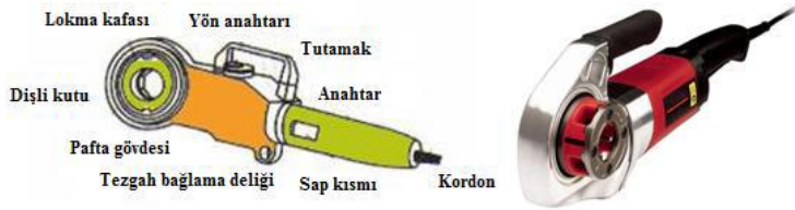
Görsel 4.13: Elektrikli el boru paftası
