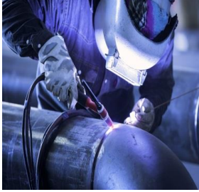
Görsel 13.18: TİG boru kaynağında çeşitli kaynak pozisyonları
