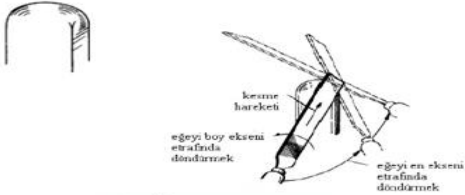
Görsel 3.15: Küresel yüzeylerin eğelenmesi
