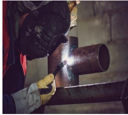
Görsel 13.19: TİG boru kaynağında ek telinin verilmesi
