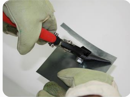
Görsel 1.37. El makası ile kesmenin yapılışı
