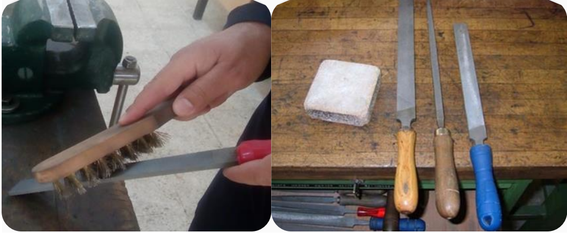
Görsel 1.23. Çalışma ortamı düzeni ve tel fırça kullanımı
