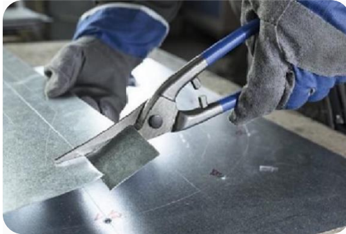
Görsel 1.37. El makası ile kesmenin yapılışı
