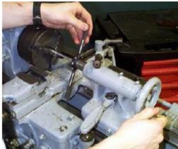
Görsel 4.32. Torna tezgâhında pafta çekme işleminin yapılışı
