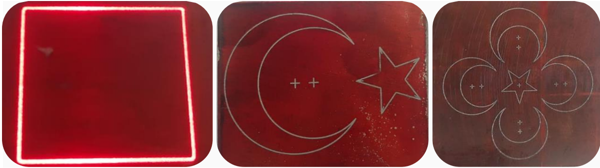
Görsel 1.29: Lazer markalama yapılmış iş parçası örnekleri
