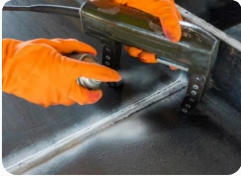
Görsel 2.6. Manyetik parçacık testi uygulaması
