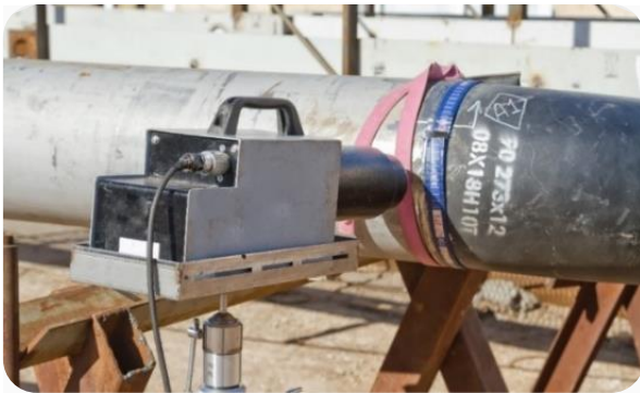
Görsel 2.9. Işın yöntemi (radyografik) testi
