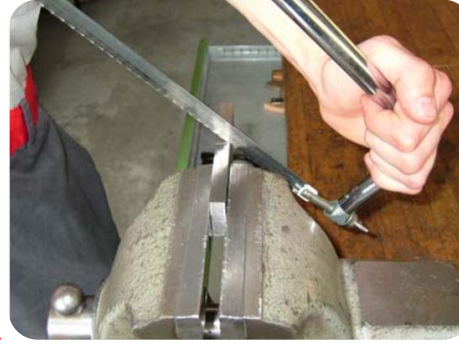
Görsel 1.36. Testere ile kesme işlemi
