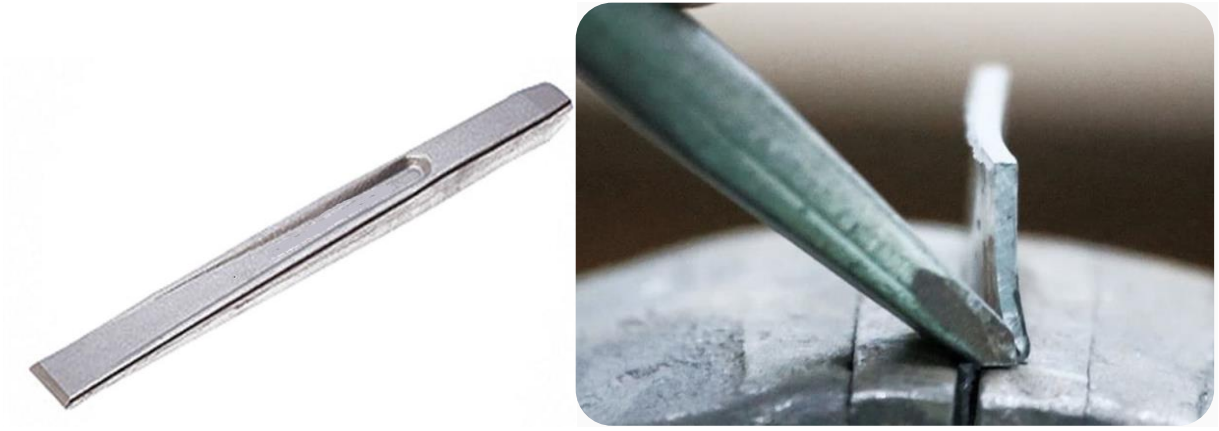
Görsel 1.38. Keski ile kesmenin yapılışı
