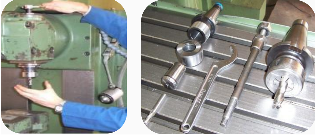
Görsel 5.27. Parmak freze çakısı, pens adaptör ve malafa milli
