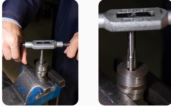
Görsel 3.29. Kılavuz ile vida açma işleminin yapılışı
