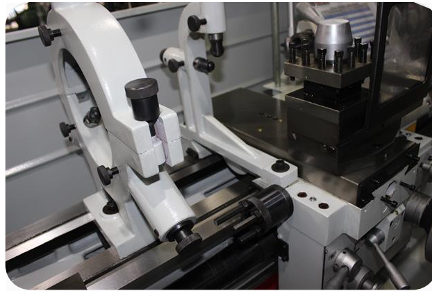
Görsel 4. 6: Yataklar (Gezer yatak ve sabit yatak)
