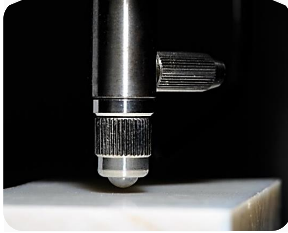
Görsel 2.13. Brinell sertlik ölçme yöntemi bilyalı uç uygulaması
