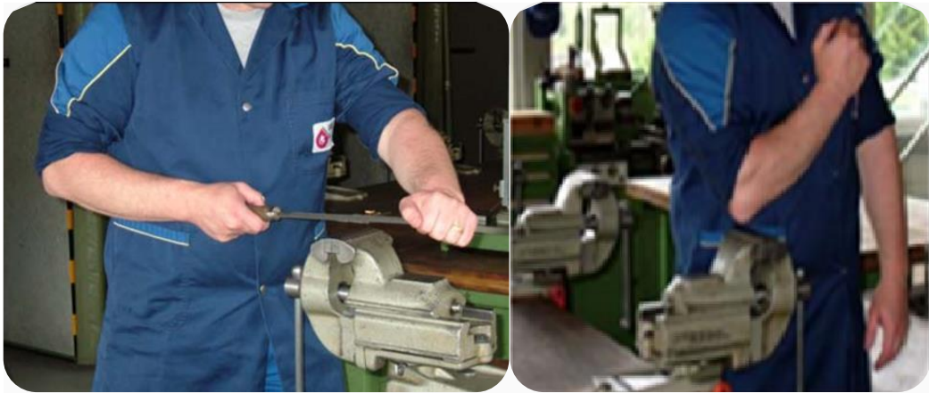
Görsel 1.20: Mengenede çalışma pozisyonu ve yüksekliğin ayarı
