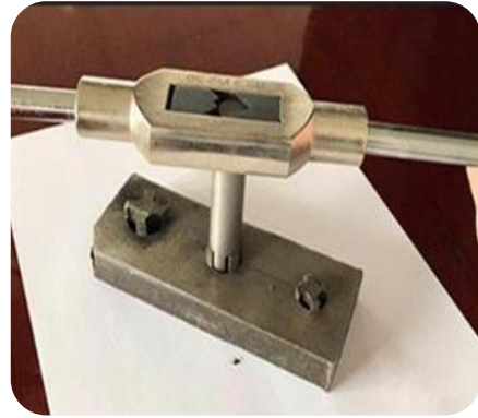
Görsel 3.31. Kırık kılavuzun çıkarılması
