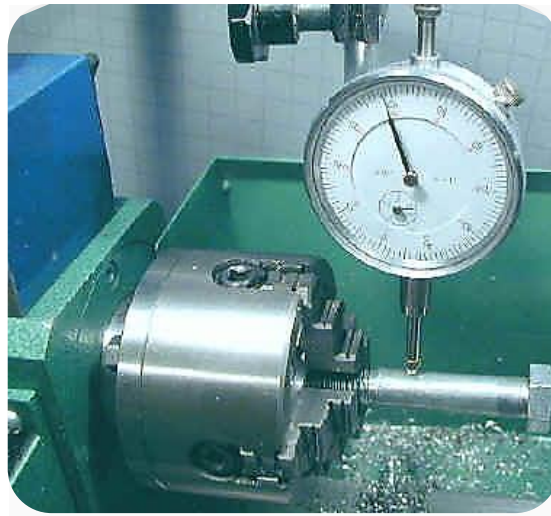
Görsel 4.20: Tomada iş parçalarının komparatör ile salgı kontrolü
