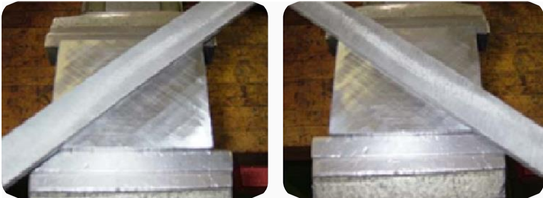
Görsel 1.22. Eğenin çapraz sürülmesi
