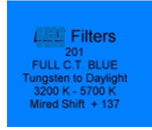
Görsel 3.21. Bir filtre katalogunda yer alan +137 Mired birimi değişiklik yapacak filtre
