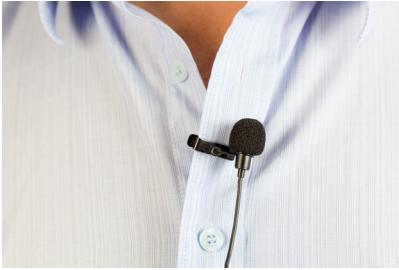
Görsel 4.16. Elektret mikrofonlar yaka mikrofonu olarak kullanılmaya uygundur.
