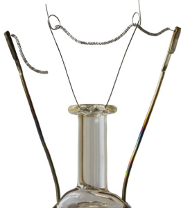
Görsel 3.40. Elektrik ampulünde, akım geçtiğinde akkor duruma gelen ince iletken tele filaman denir.
