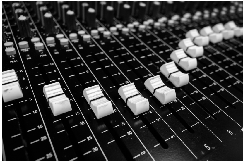
Görsel 1.17. Ses mikseri üzerinde Fader adı verilen sürgü kolları bulunur.
