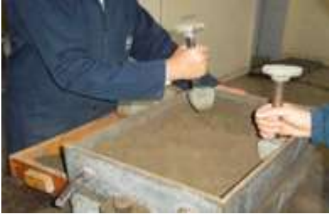
Resim 2.6: Sivri tokmak ile dolgu kumunun sıkıştırılması
