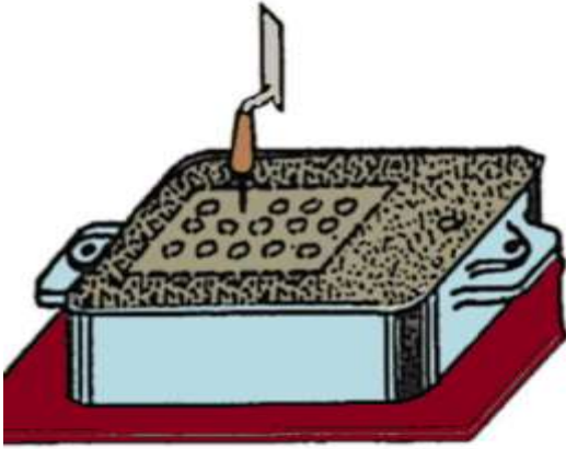
Resim 2.56: Çivinin mala sapı ile tutturulması
