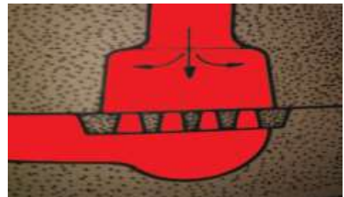
Resim 2.44: Cürüflük üzerine yerleştirilmiş süzgeç
