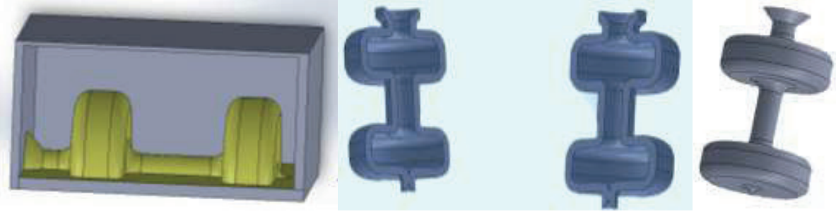
Resim 2.34: Kabuk kalıp yöntemi
