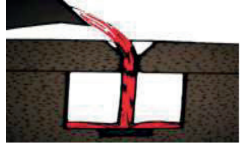
Resim 2.41: Kalıp tabanına soğutucu konmuş düz çağlayan yolluk
