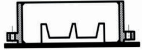
Resim 2.50: Model ve derecenin kalıplama altlığına yerleştirilmesi
