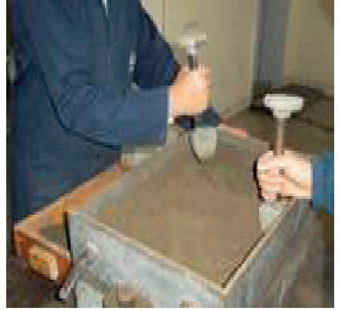
Resim 2.6: Sivri tokmak ile dolgu kumunun sıkıştırılması
