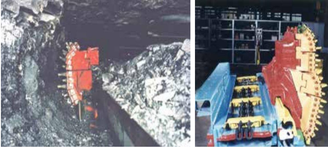
Görsel 3.4: Koparıcı saban (sol) ve kayıcı saban (sağ)
