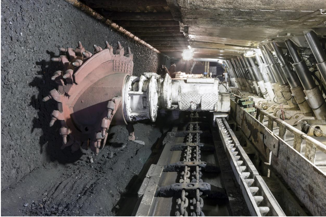
Görsel 3.17: Kömür madeninde kesici yükleyici ile birlikte kullanılan zincirli konveyör
