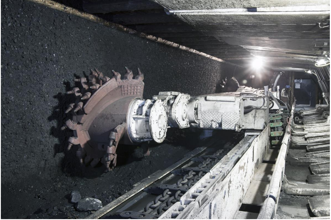
Görsel 3.10: Kesici yükleyici makinenin kömür madenindeki uygulaması
