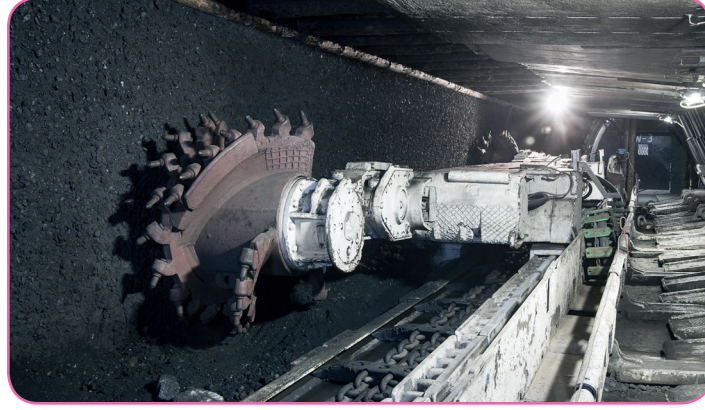
Görsel 3.13: Kesici yükleyici makinenin kömür madenindeki uygulaması
