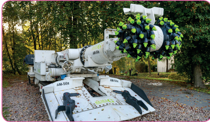
Görsel 3.10: Kol eksenine dik galerî açma makinesi
