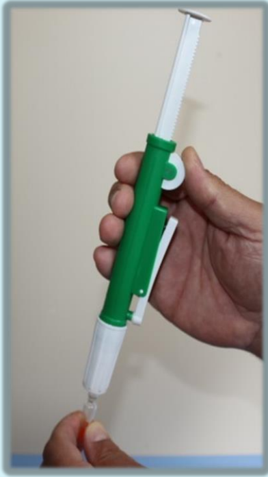
Görsel 2.14: Pipet pompasının pipete takılışı
