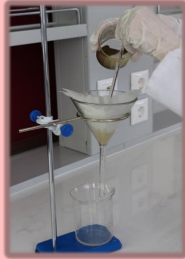
Görsel 1.16: Süzme işlemi ve çökeleğin filtre kâğıdına aktarılması
