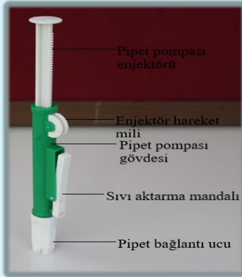
Görsel 2.13: Pipet pompası ve üzerindeki işlev noktaları
