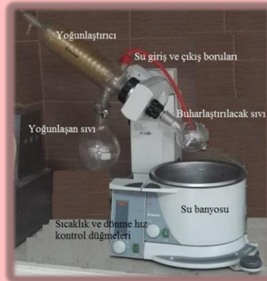
Görsel 4.2: Soxhalet cihazı, soxhalet düzeneği ve döner buharlaştırıcı
