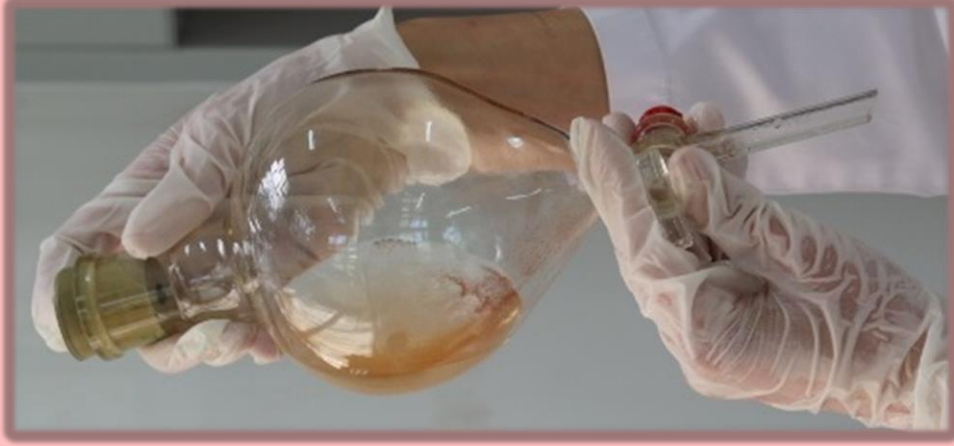
Görsel 4.1: Ayırma hunisini, ekstraksiyon sırasında uygun tutma metodu
