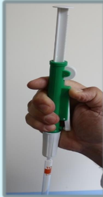
Görsel 2.17: Pipet pompasının mandalına basılması
