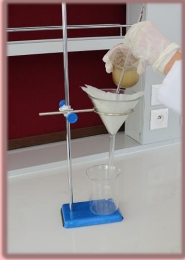
Görsel 1.16: Süzme işlemi ve çökeleğin filtre kâğıdına aktarılması
