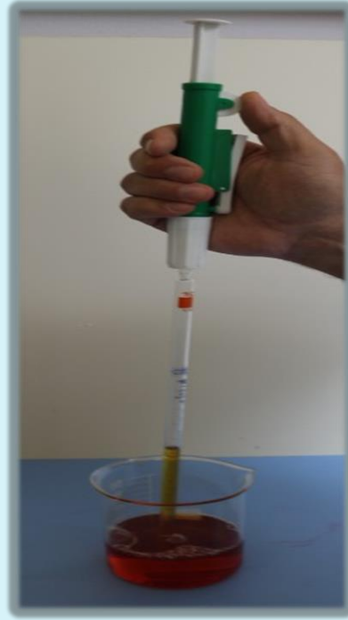
Görsel 2.15: Pipet pompası ile sıvı çekme
