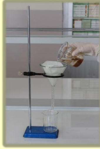
Görsel 2.2: Süzme işlemi ve çökeleğin süzgeç kâğıdına aktarılması
