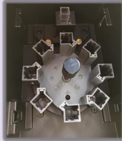
Görsel 2.3: Spektrofotometre içerisinde küvetin yerleştirildiği yuvalar.
