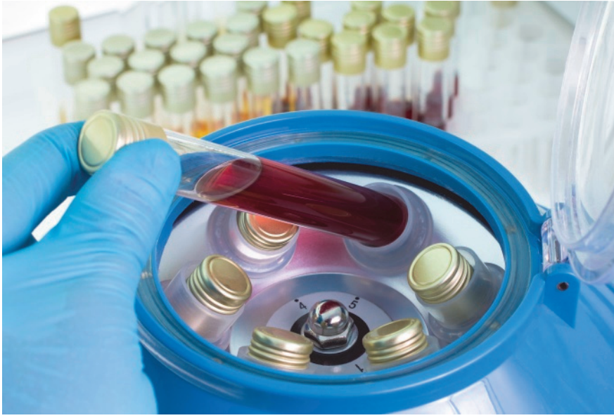
Görsel 5.3.3: Santrifüj cihazına tüp yerleştirilmesi
