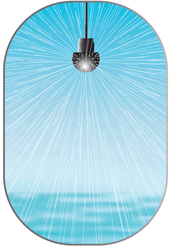
Şekil 2.10: Sabit başlıklı CIP sistemi
