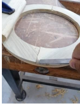
Görsel 7.31: Tutkal artıklarının temizlenmesi
