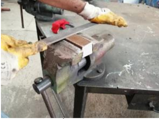
Görsel 3.9: İş parçasının eğelenmesi
