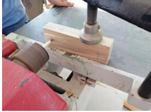
Görsel 4.25: İş parçasının makine tablasına bağlanması
