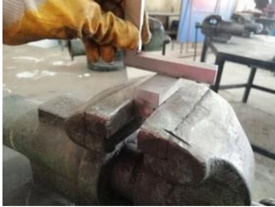
Görsel 3.11: İş parçasının kıl gönye ile enine yüzey kontrolü
