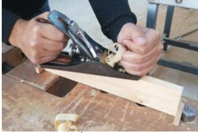
Görsel 3.29: İş parçasının rendelenmesi
