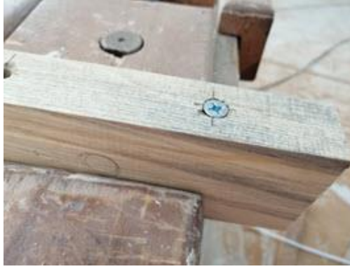
Görsel 4.41: Havşa açılmış iş parçasına vida montajı
