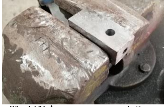
Görsel 4.31: İş parçasının mengeneye bağlanması
