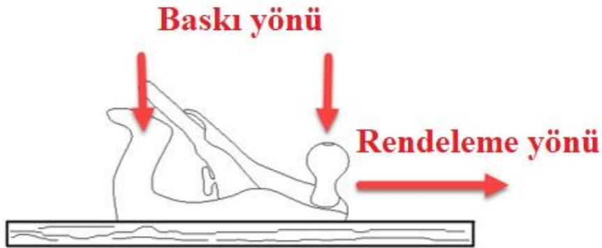
Şekil 3.2: Rende kullanımı (çift yönlü baskılama)
