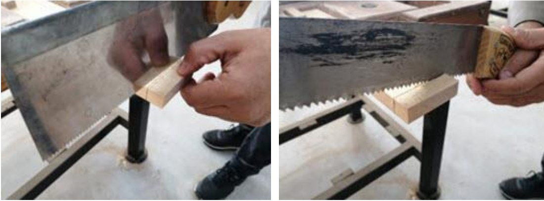
(a) (b) Görsel 3.60 (a, b): İş parçasının fazla kısımlarının kesilmesi
