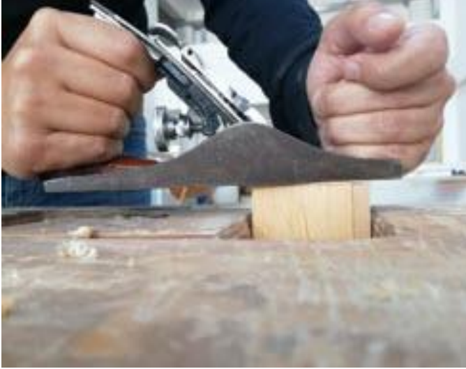
Görsel 3.57: İş parçasının ilk alın kısmının rendelenmesi
