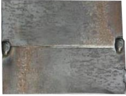
Görsel 6.27: Hatalı çekilmiş punta
