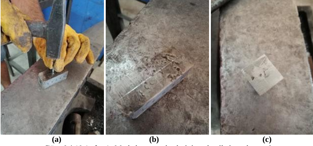
Görsel 4.10 (a, b, c): Markalama merkezlerinin nokta ile işaretlenmesi
