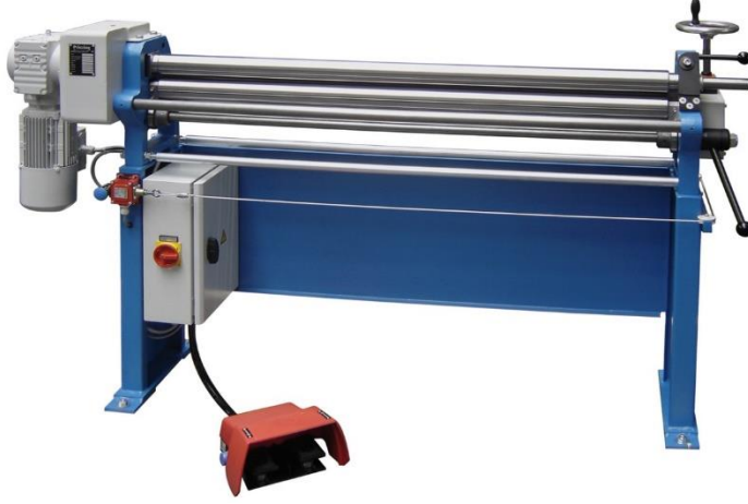
Görsel 5.6: Elektrikli, 3 toplu silindir makinesi
