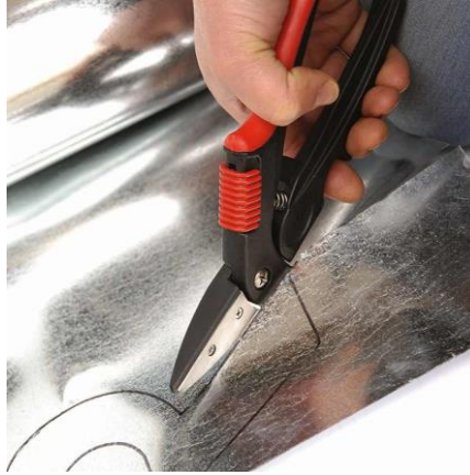
Görsel 7.8: Metal sac kesme makası ile parçanın kesilmesi
