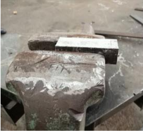
Görsel 3.43: İş parçasının mengeneye bağlanması
