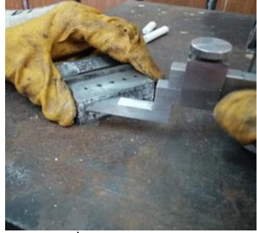
Görsel 2.15: İş parçasının mihengir ile çizilmesi
