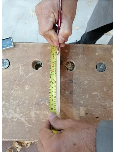
Görsel 2.22: İş parçasının ölçülmesi
