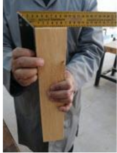
Görsel 3.58: İş parçasının gönye ile kontrolü
