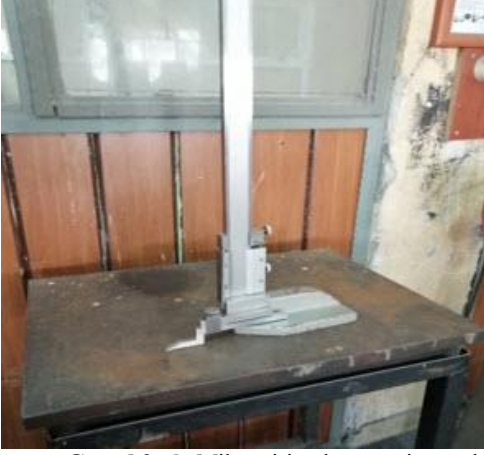
Görsel 3.13: Mihengirin pleyt üzerine yerleştirilmesi
