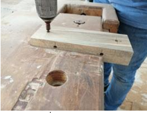
Görsel 4.39: İş parçasına havşa açılması
