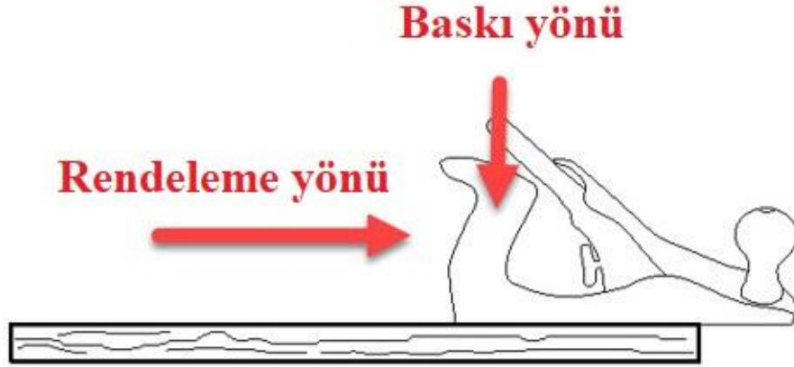
Şekil 3.3: Rende kullanımı (arka baskılama)
