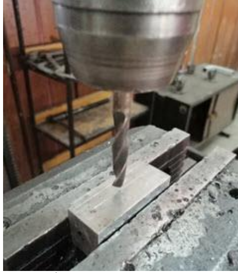
Görsel 4.13: İş parçasının mengeneye bağlanması
