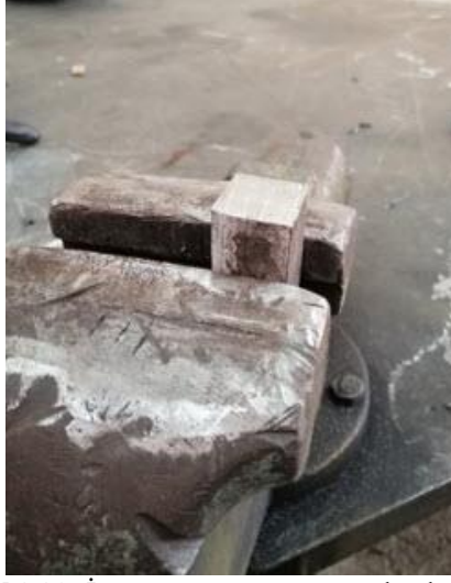
Görsel 3.39: İş parçasının mengeneyle bağlanması
