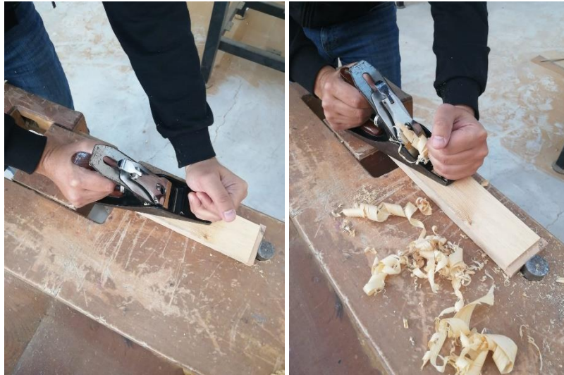
Görsel 3.26 (a, b): İş parçasının rendelenmesi
