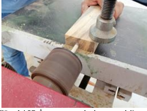
Görsel 4.27: İş parçasının alın kısmının delinmesi
