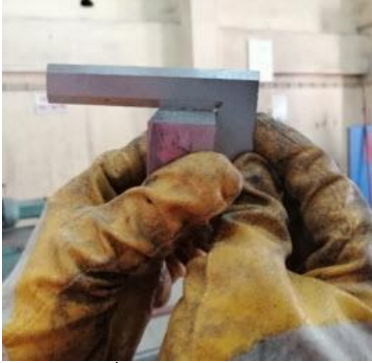
Görsel 3.19: İş parçasının kıl gönye ile son kontrolü
