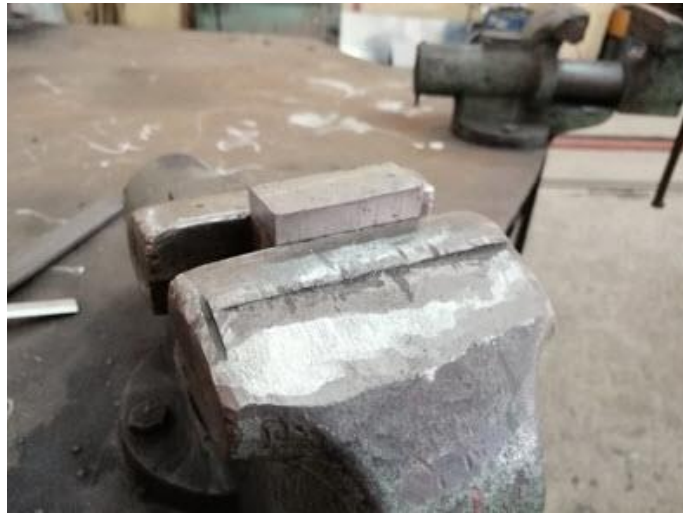
Görsel 3.8: İş parçasının mengeneye bağlanması
