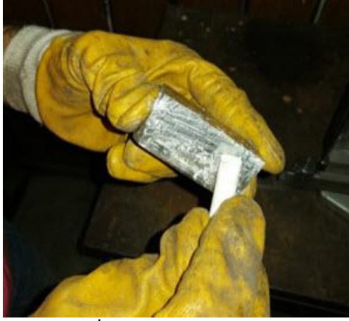
Görsel 2.14: İş parçasının tebeşir ile boyanması
