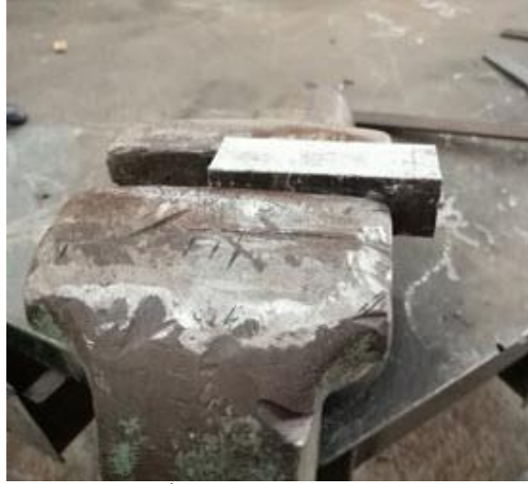
Görsel 2.30: İş parçasının mengeneye bağlanması
