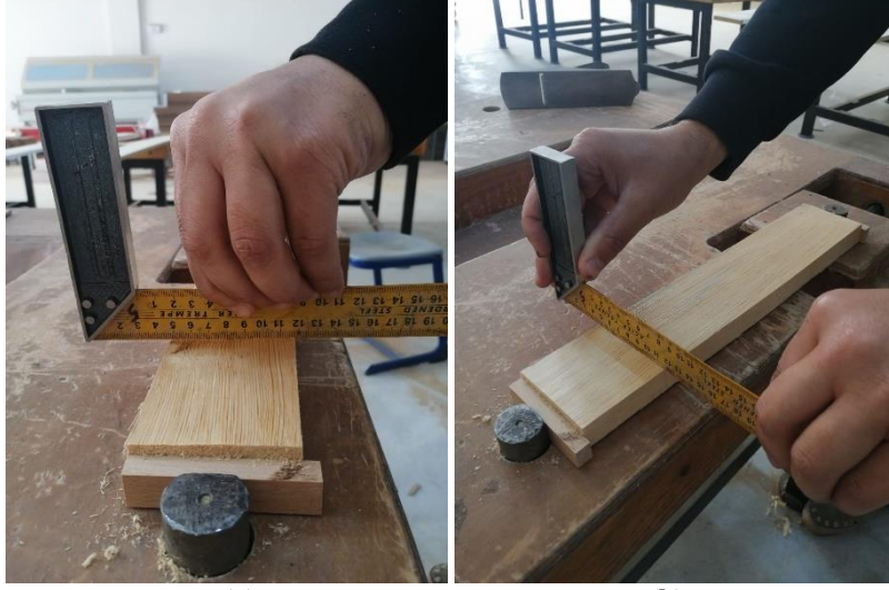
(a) (b) Görsel 3.27 (a, b): İş parçasının yüzey kontrolü
