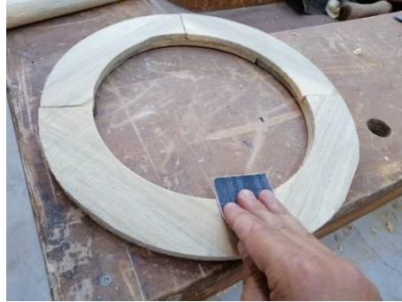
Görsel 7.33: Zımpara ile yüzey temizliği
