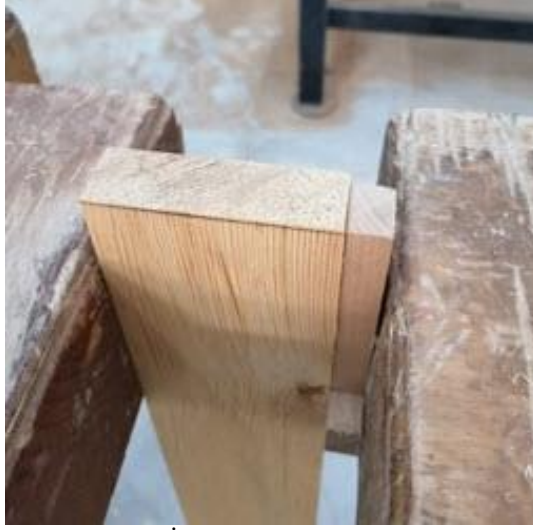
Görsel 3.56: İş parçasının tezgâha bağlanması
