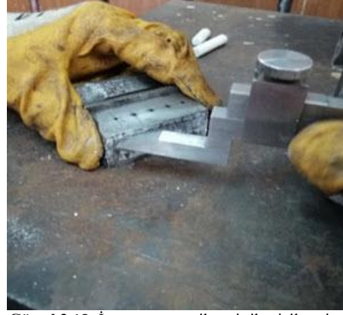
Görsel 3.16: İş parçasının mihengir ile çizilmesi
