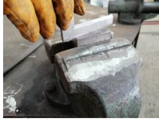
Görsel 3.10: İş parçasının kıl gönye ile boyuna yüzey kontrolü
