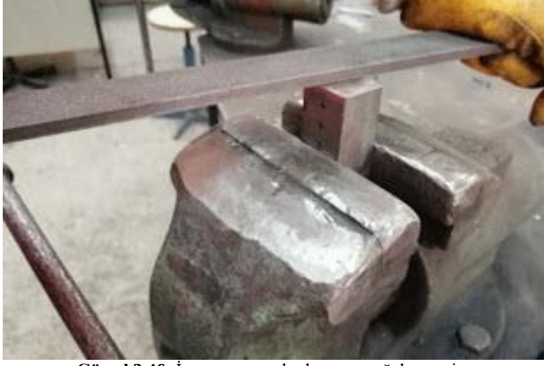
Görsel 3.46: İş parçasının alın kısmının eğelenmesi
