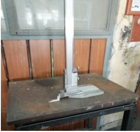
Görsel 2.12: Mihengirin pleyt üzerine yerleştirilmesi
