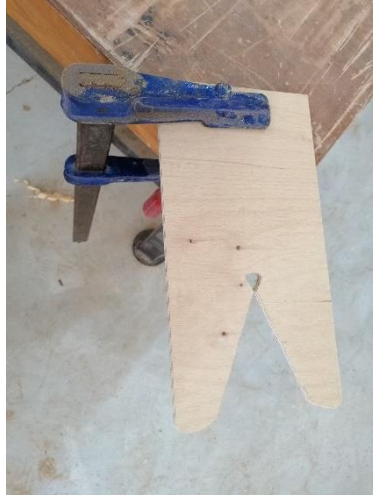
Görsel 7.27: Kıl testere sehpasının marangoz tezgâhına bağlanması
