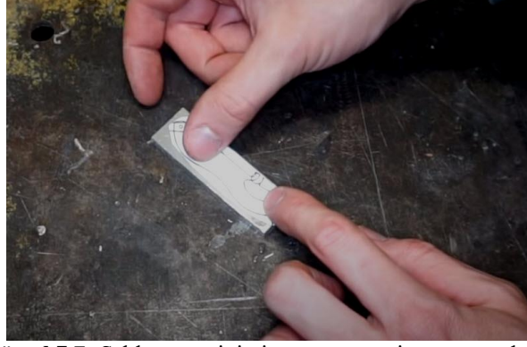
Görsel 7.7: Şablon resminin iş parçası üzerine yapıştırılması
