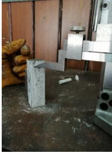
Görsel 3.38: İş parçasının markalanması
