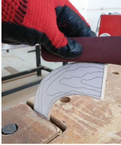
Görsel 7.15: Şablonun kenar fazlalıklarının zımpara ile düzeltilmesi
