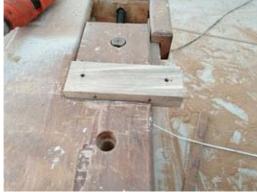
Görsel 4.38: İş parçasının tezgâha bağlanması
