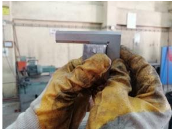
Görsel 3.12: İş parçasının kıl gönye ile yüzey kontrolü
