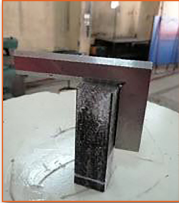
Görsel 3.35: İş parçasının kıl gönye ile son kontrolü
