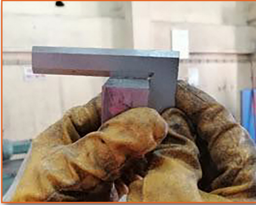
Görsel 3.12: İş parçasının kıl gönye ile son kontrolü
