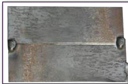
Görsel 6.18: Hatalı çekilmiş punta
