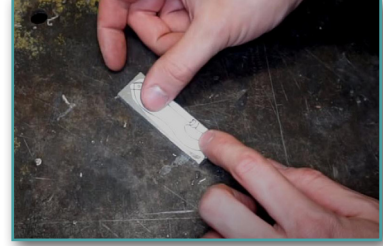
Görsel 7.7: Şablon resminin iş parçası üzerine yapıştırılması
