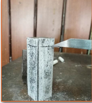
Görsel 3.27: İş parçasının mihengir ile markalanması
