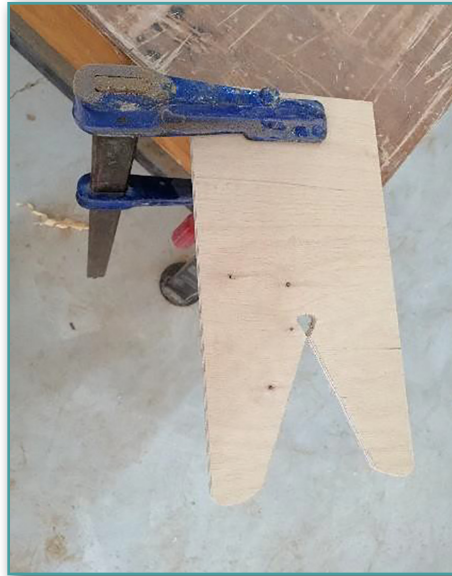
Görsel 7.21: Kıl testere sehpasının marangoz tezgâhına bağlanması
