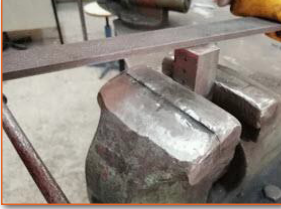
Görsel 3.33: İş parçasının alın kısmının eğelenmesi
