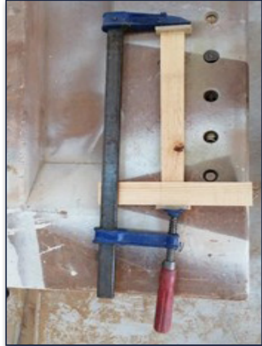
Görsel 1.57: İş parçasının işkence yardımıyla sıkıştırılması
