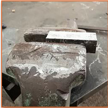
Görsel 3.29: İş parçasının mengeneyle bağlanması
