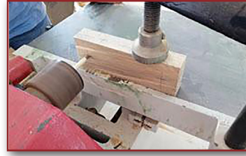
Görsel 4.21: İş parçasının makine tablasına bağlanması
