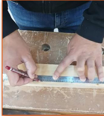
Görsel 3.19: İş parçasının markalanması
