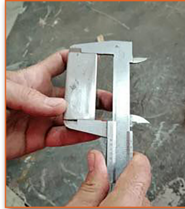
Görsel 3.36: İş parçasının kumpas ile son kontrolü
