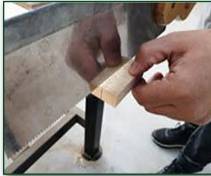
Görsel 2.35: İş parçasının fire kısmına iz yapılması
