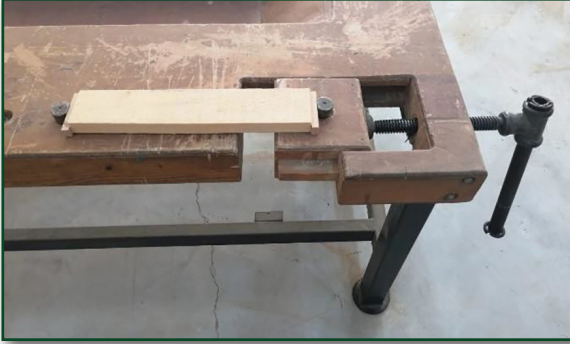
Görsel 2.29: İş parçasının tezgâh mengenesine yatay şekilde bağlanması
