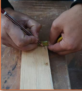
Görsel 3.18: İş parçasının işaretlenmesi
