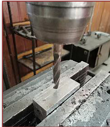
Görsel 4.11: İş parçasının mengeneye bağlanması
