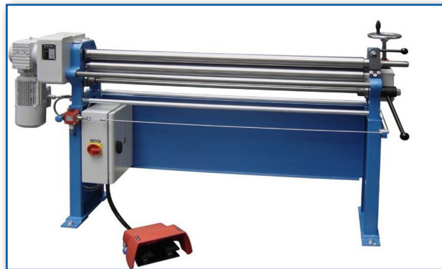
Görsel 5.2: Elektrikli, üç toplu silindir makinesi
