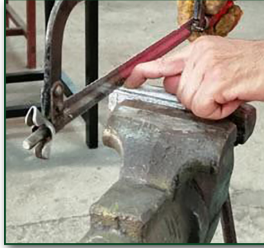
Görsel 2.22: Demir testeresinin iş parçasının üzerine yerleştirilmesi
