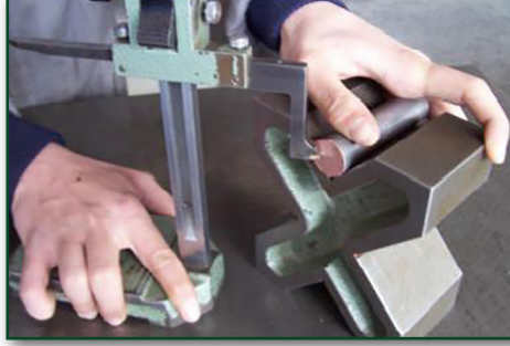
Görsel 2.11: Yuvarlak iş parçasının markalanması
