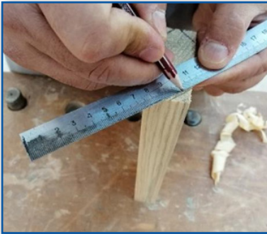
Görsel 5.6: İş parçasının ölçülmesi
