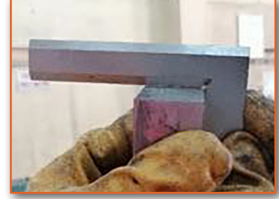
Görsel 3.5: İş parçasının kıl gönye ile yüzey kontrolü
