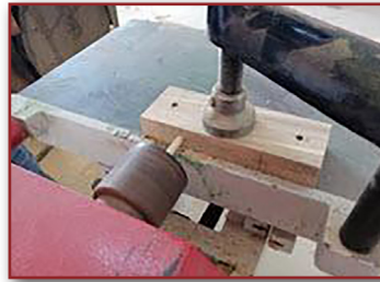
Görsel 4.23: İş parçasının dar yüzeyinin delinmesi
