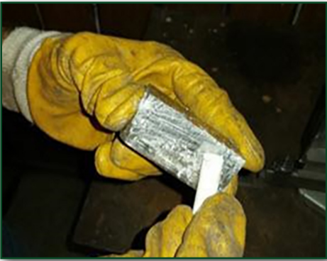
Görsel 2.7: İş parçasının tebeşir ile boyanması
