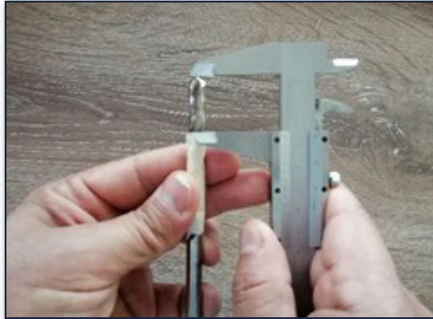
c) Kumpas ile derinlik ölçümü
