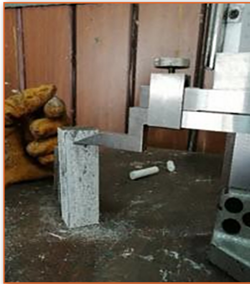
Görsel 3.23: İş parçasının mihengir ile markalanması
