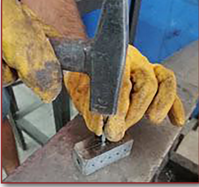
Görsel 4.6: Markalama merkezlerinin nokta ile işaretlenmesi
