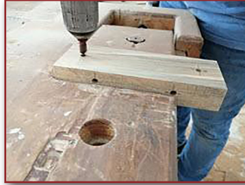
Görsel 4.31: İş parçasına havşa açılması
