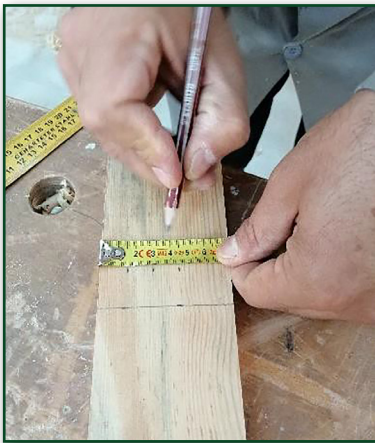
Görsel 2.26: İş parçasının işaretlenmesi
