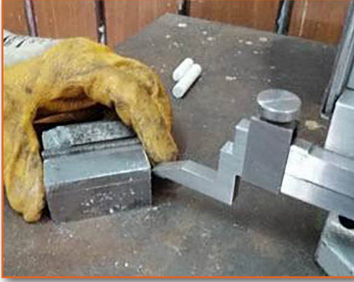
Görsel 3.10: İş parçasının mihengir ile kontrolü
