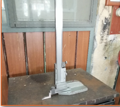
Görsel 3.6: Mihengirin pleyt üzerine yerleştirilmesi
