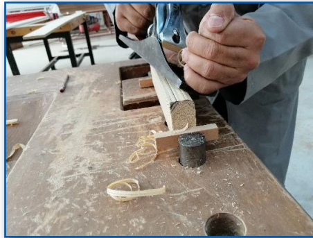
Görsel 5.10: İş parçasına pah açılması
