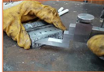
Görsel 3.9: İş parçasının mihengir ile çizilmesi
