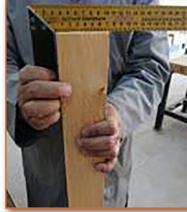
Görsel 3.41: İş parçasının gönye ile kontrolü
