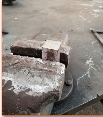
Görsel 3.24: İş parçasının mengerneye bağlanması
