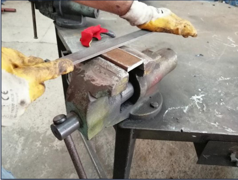
Görsel 1.52: Metal iş parçasını eğleme işlemi
