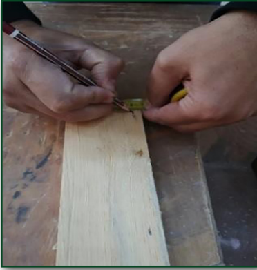
Görsel 2.15: İş parçasının işaretlenmesi
