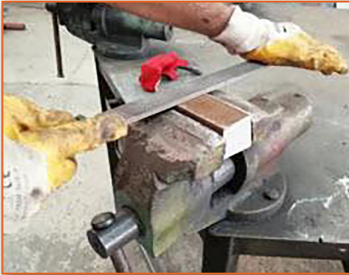
Görsel 3.2: İş parçasının eğelenmesi
