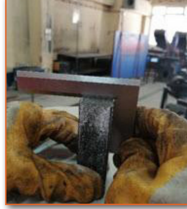
Görsel 3.34: İş parçasının gönye ile kontrolü
