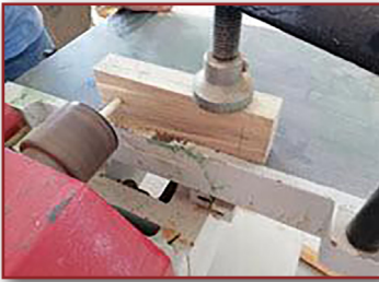
Görsel 4.22: İş parçasının geniş yüzeyinin delinmesi
