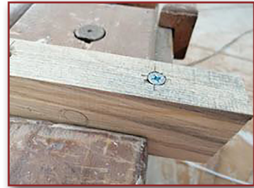
Görsel 4.33: Havşa açılmış iş parçasına vida montajı
