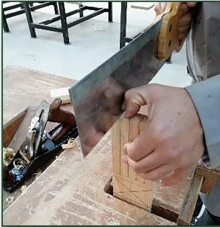
Görsel 2.31: İş parçasına dikey konumda iz yapılması
