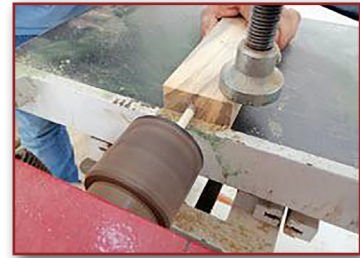
Görsel 4.24: İş parçasının alın kısmının delinmesi
