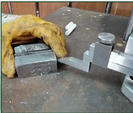
Görsel 2.9: İş parçasının mihengir ile kontrolü
