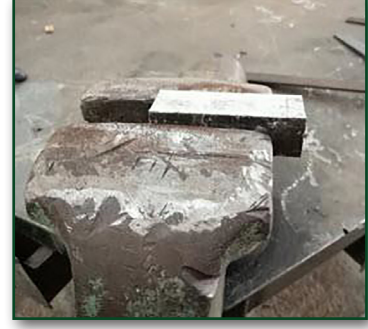
Görsel 2.21: İş parçasının mengeneye bağlanması
