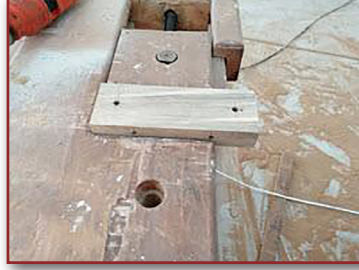
Görsel 4.30: İş parçasının tezgâha bağlanması
