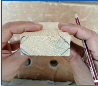
Görsel 5.7: İş parçasının markalanması
