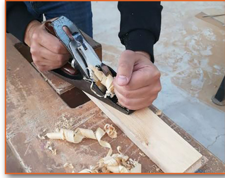
Görsel 3.16: İş parçasının rendelenmesi
