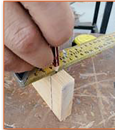
Görsel 3.43: İş parçasının markalanması
