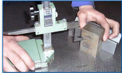
Görsel 5.5: İş parçasının mihengir ile markalanması
