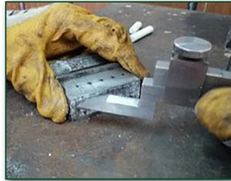
Görsel 2.8: İş parçasının mihengir ile çizilmesi
