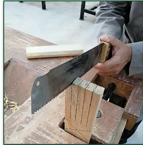
Görsel 2.32: İş parçasının dikey konumda kesilmesi
