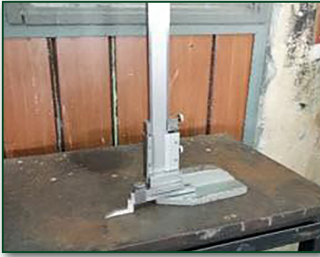
Görsel 2.5: Mihengirin pleyt üzerine yerleştirilmesi
