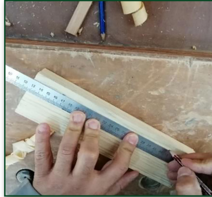
Görsel 2.16: İş parçasının ölçülmesi
