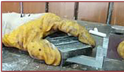
Görsel 4.3: İş parçasının mihengir ile markalanması
