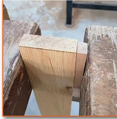
Görsel 3.39: İş parçasının tezgâha bağlanması
