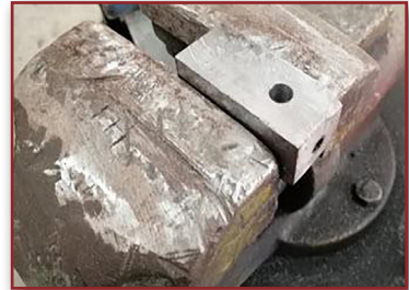
Görsel 4.25: İş parçasının mengeneyle bağlanması
