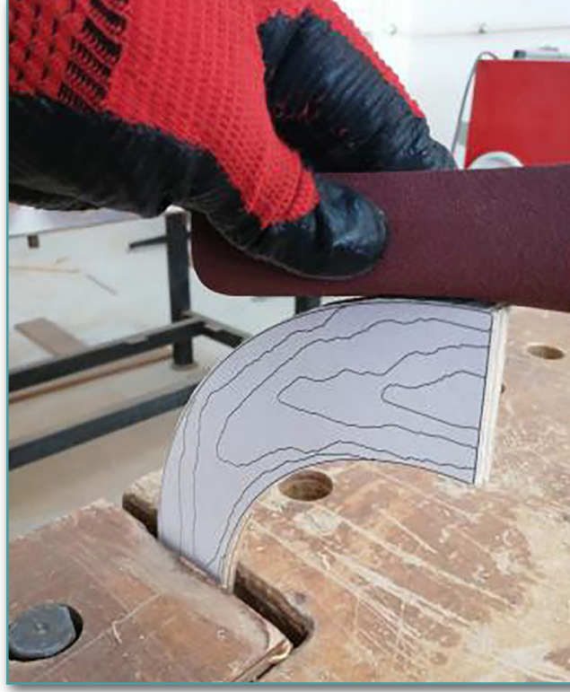
Görsel 7.15: Şablonun kenar fazlalıklarının zımpara ile düzeltilmesi
