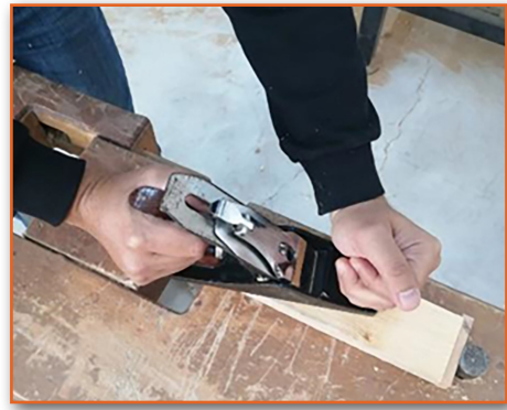
Görsel 3.15: Rendenin ön kısmına baskı uygulanması
