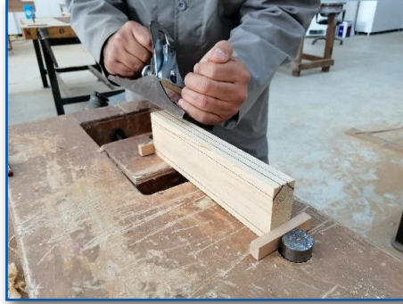
Görsel 5.9: İş parçasının tezgâha bağlanması ve rendelenmesi
