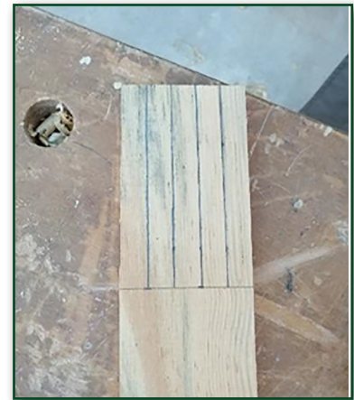
Görsel 2.27: İş parçasının markalanması
