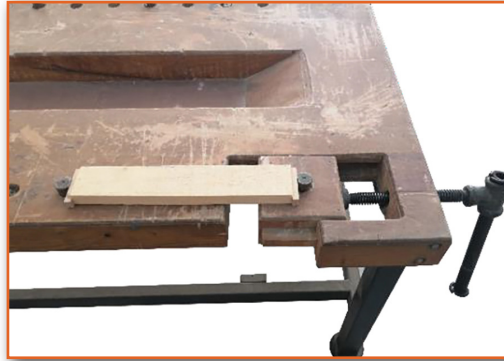
Görsel 3.14: İş parçasının tezgâha bağlanması
