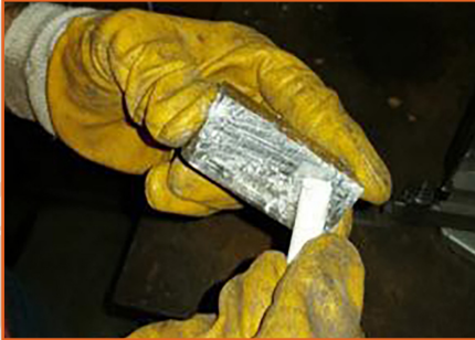
Görsel 3.8: İş parçasının tebeşir ile boyanması
