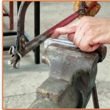
Görsel 3.30: Demir testeresinin iş parçasının üzerine yerleştirilmesi
