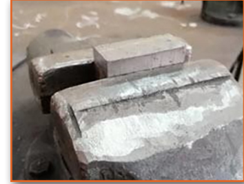
Görsel 3.1: İş parçasının mengeneye bağlanması
