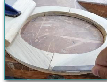
Görsel 7.25: Tutkal artıklarının temizlenmesi
