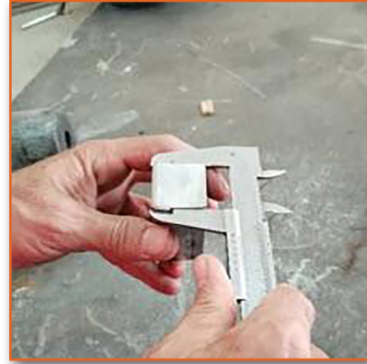
Görsel 3.13: İş parçasının kumpas ile son kontrolü
