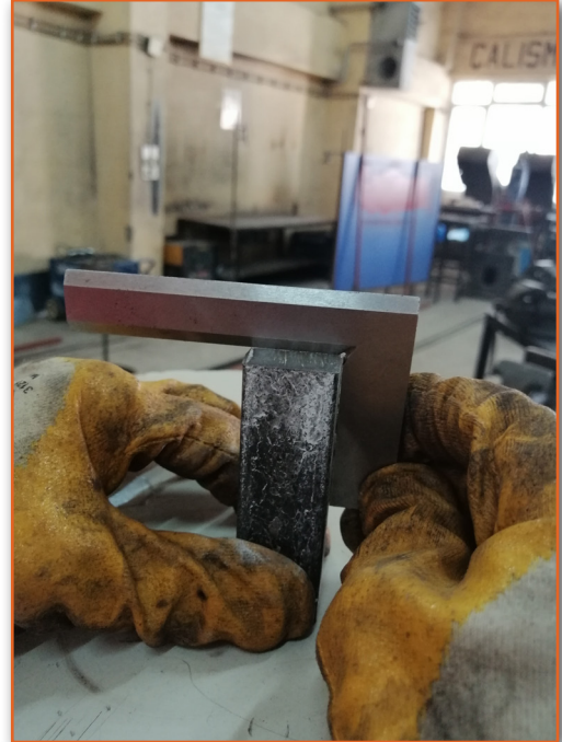
Görsel 3.26: İş parçasının gönye ile kontrolü
