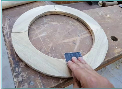
Görsel 7.27: Zımpara ile yüzey temizliği
