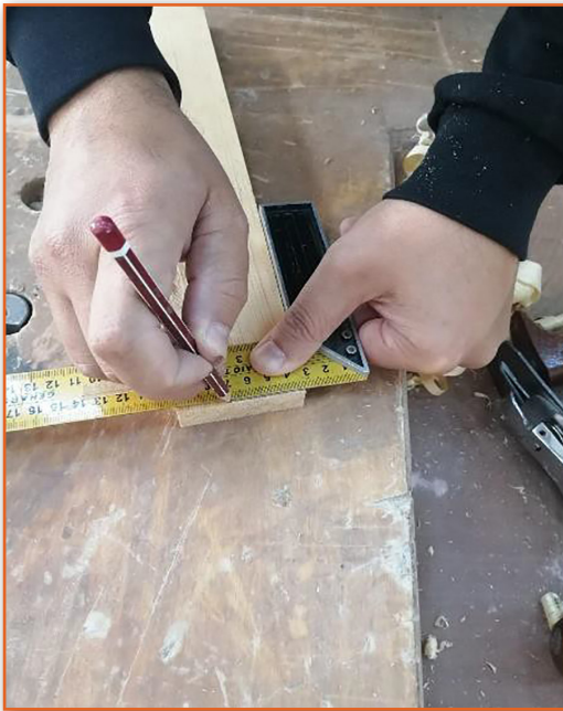
Görsel 3.37: İş parçasının ilk alın kısmının işaretlenmesi
