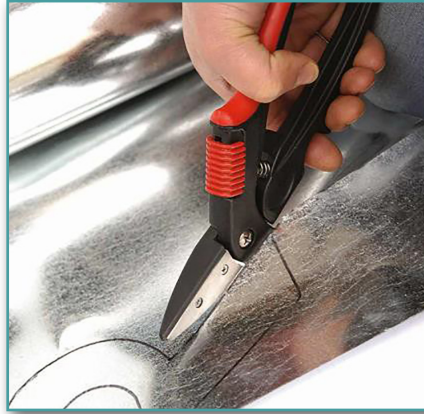
Görsel 7.8: Parçanın metal sac kesme makası ile kesilmesi
