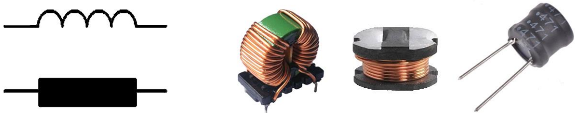
Şekil 1.34: Bobin sembolü ve görünüşleri
