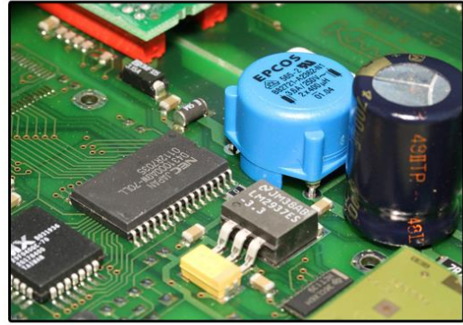
Şekil 2.39: Kondansatör yapısı ve devredeki görünümü
