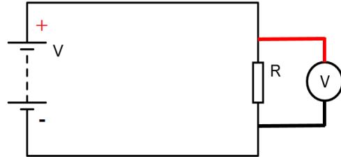
Şekil 1.27: Ölçü aletinin bağlanması
