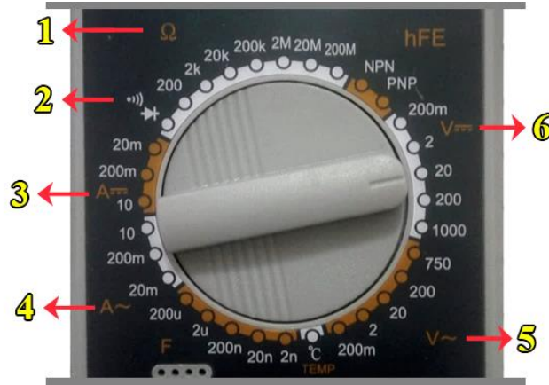
Şekil 1.14: Dijital multimetre kademe anahtarı
