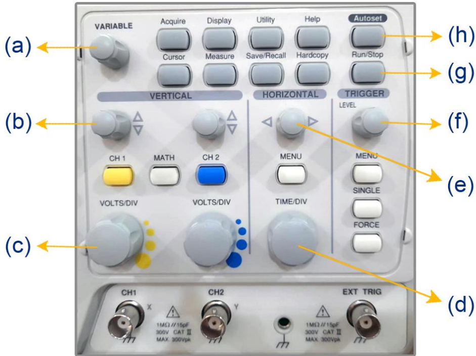
Şekil 2.18: Dijital osiloskop tuşları
