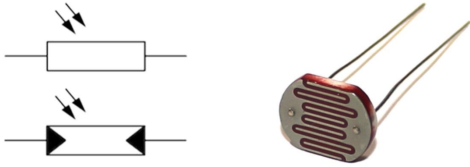
Şekil 3.22: LDR sembolü ve görünümü
