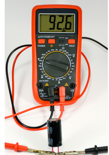
Görsel 4.34: Kondansatörün dijital multimetre ile testi
