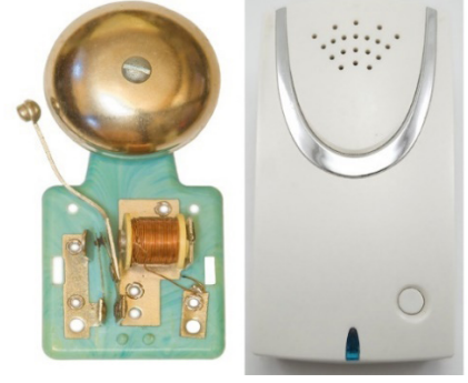
Görsel 6.4: Elektromanyetik ve elektronik zil
