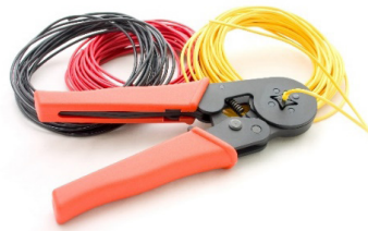
Görsel 5.25: Pinin sıkıştırılması
