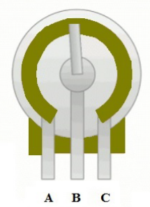
Görsel 3.14: Potansiyometre içyapısı
