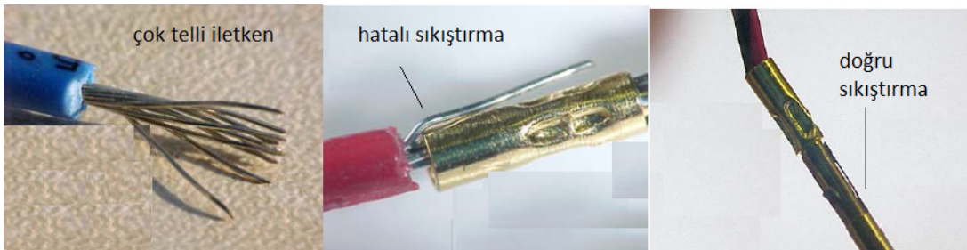
Görsel 5.12: Yanlış ve doğru pin bağlantısı
