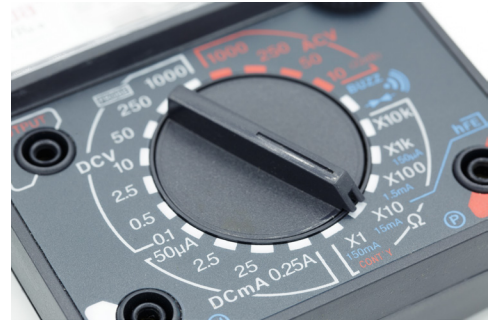
Görsel 4.35: Kondansatörün analog AVOmetre ile test kademesi
