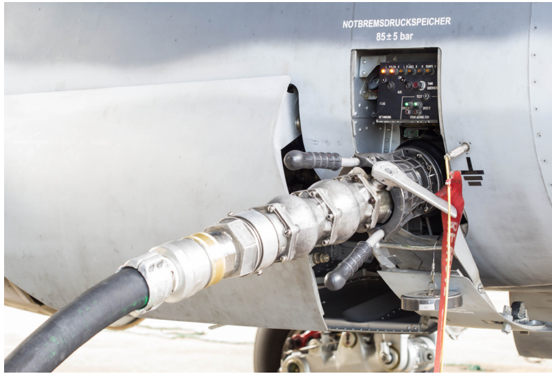
Görsel 5.33: Yakıt deposu ve yakıt deposunun topraklanması
