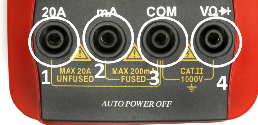
Görsel 2.18: Dijital AVOMETRE prob bağlantı terminalleri
