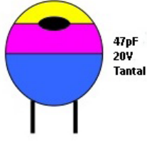
Şekil 4.14: Birinci tip tantal kondansatör renk bantları
