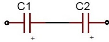
Şekil: 4.18: İki kondansatörün seri bağlantısı
