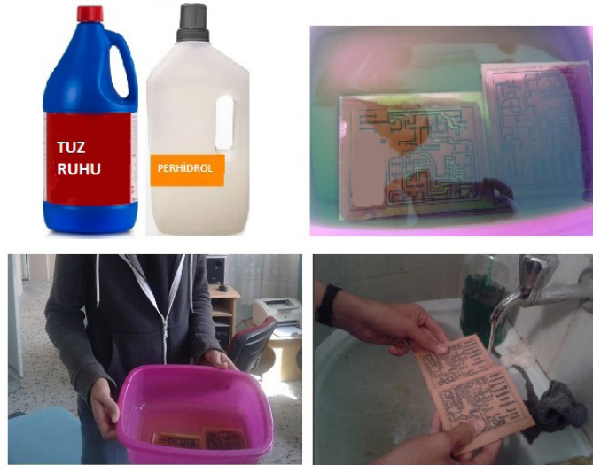
Görsel 8.34: Tuz ruhu perhidrol karışımı ile bakır plaket eritilmesi
