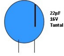
Şekil 4.15: İkinci tip tantal kondansatör renk bantları
