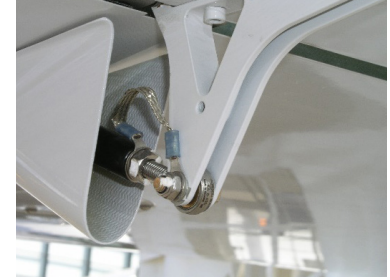
Görsel 5.31: Uçakta hareketli parça ile gövde arasında sürekliliği sağlamak amacı ile yapılan bağlantı
