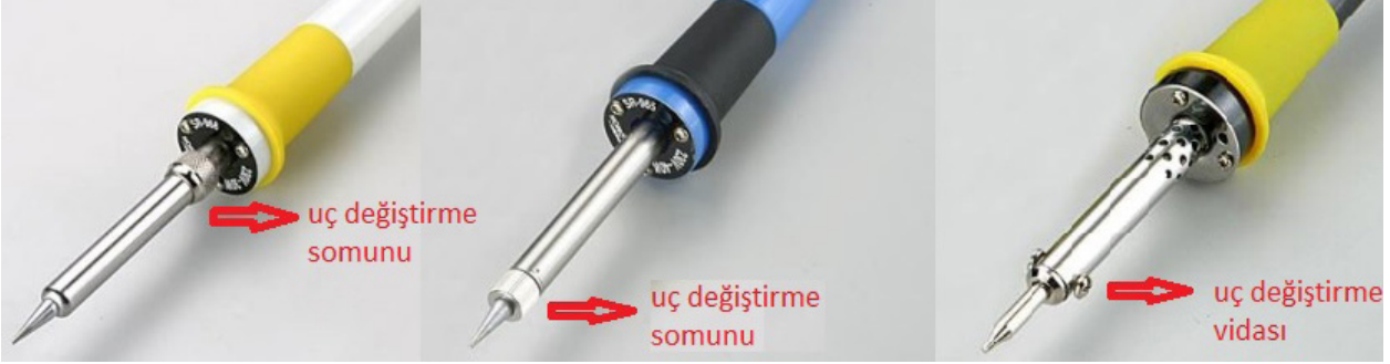
Görsel 8.10: Kalem havya uçlarından değiştirilmesi
