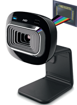
Görsel 4.45: Ağ kamerası (optik algılayıcı)
