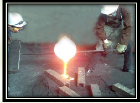
Resim 1.4: Kalıplara sıvı metal dökümü
