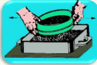
Şekil 1.3: Elek ile kum eleme
