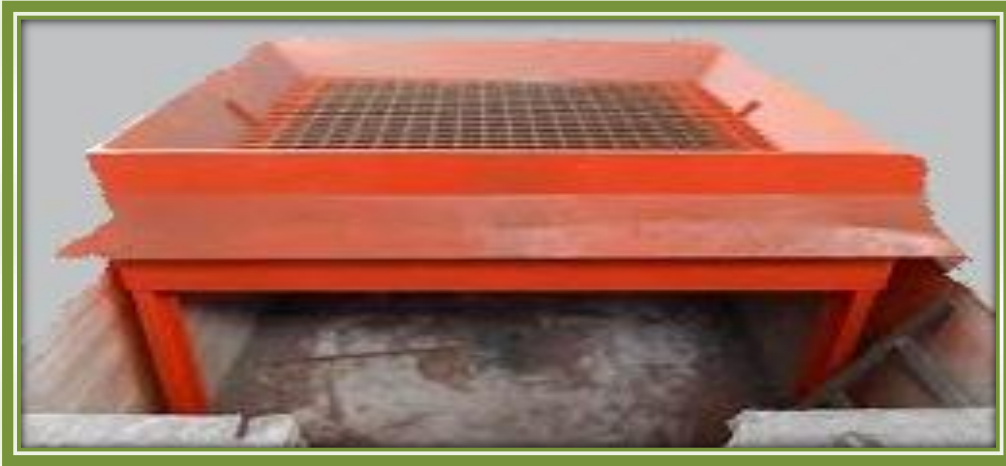
Resim 6.1: Kalıp bozma makinesi (Sarsak)
