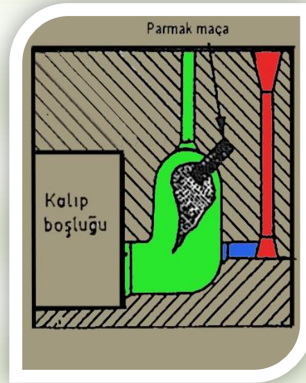
Şekil 2.38: Parmak maça yerleştirilmesi
