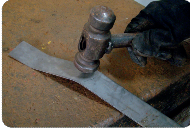
Görsel: 4.3: Örs üzerinde sac düzeltme
