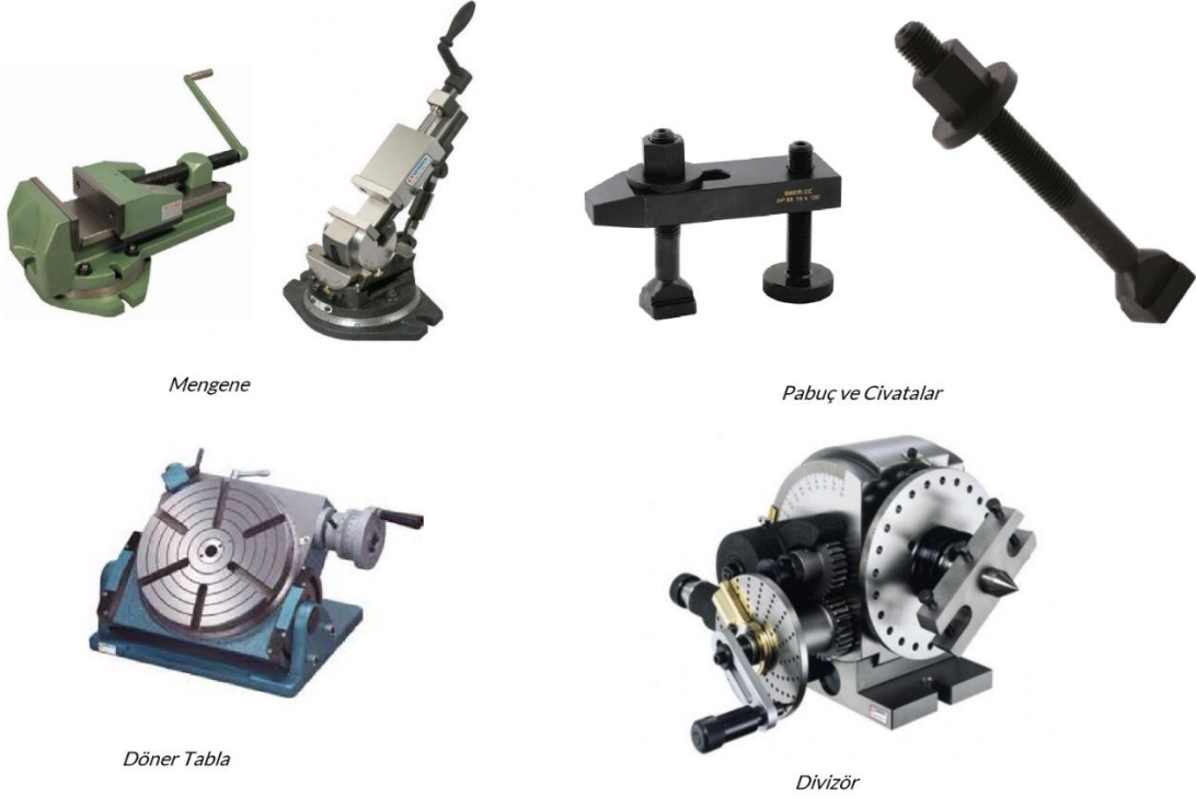
Şekil 1.4.2: İş parçası bağlama aparatları
