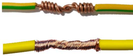
Şekil 4.2.2: Düz ek bağlantısı
