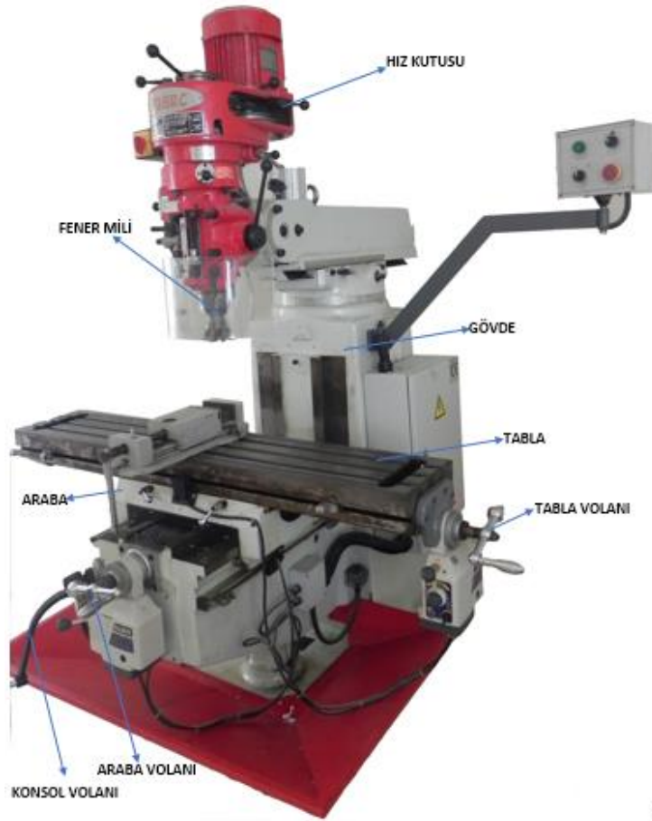
Şekil 1.4.1: Freze tezgâh kısımları
