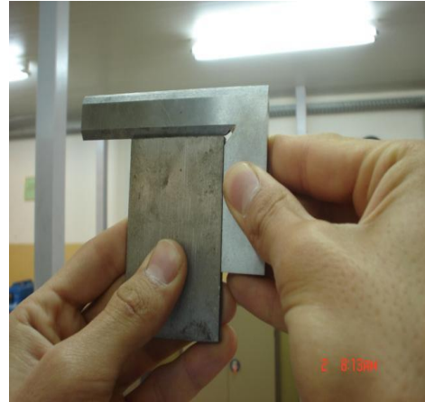
Şekil 1.2.1: Gönye ile yüzey kontrolü
