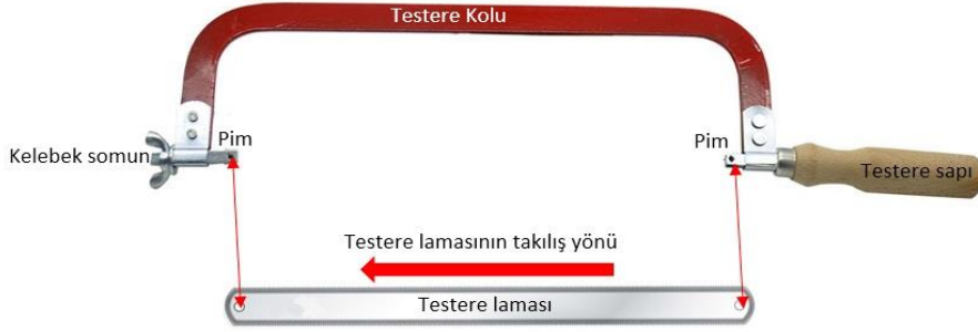
Şekil 1.2.12: Testere ve testere laması
