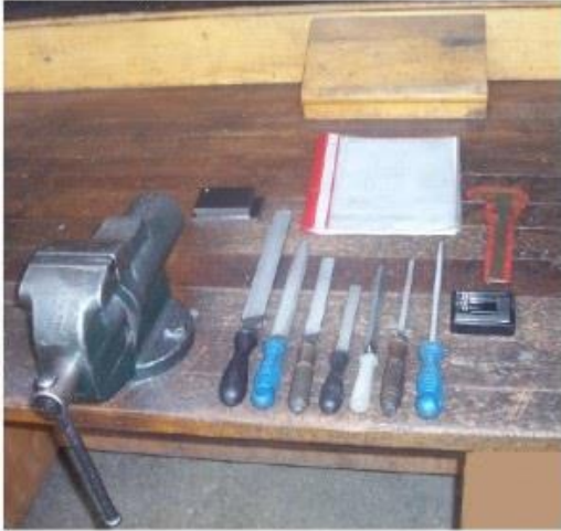
Şekil 1.2.11. Tesviyeci tezgâhı düzeni
