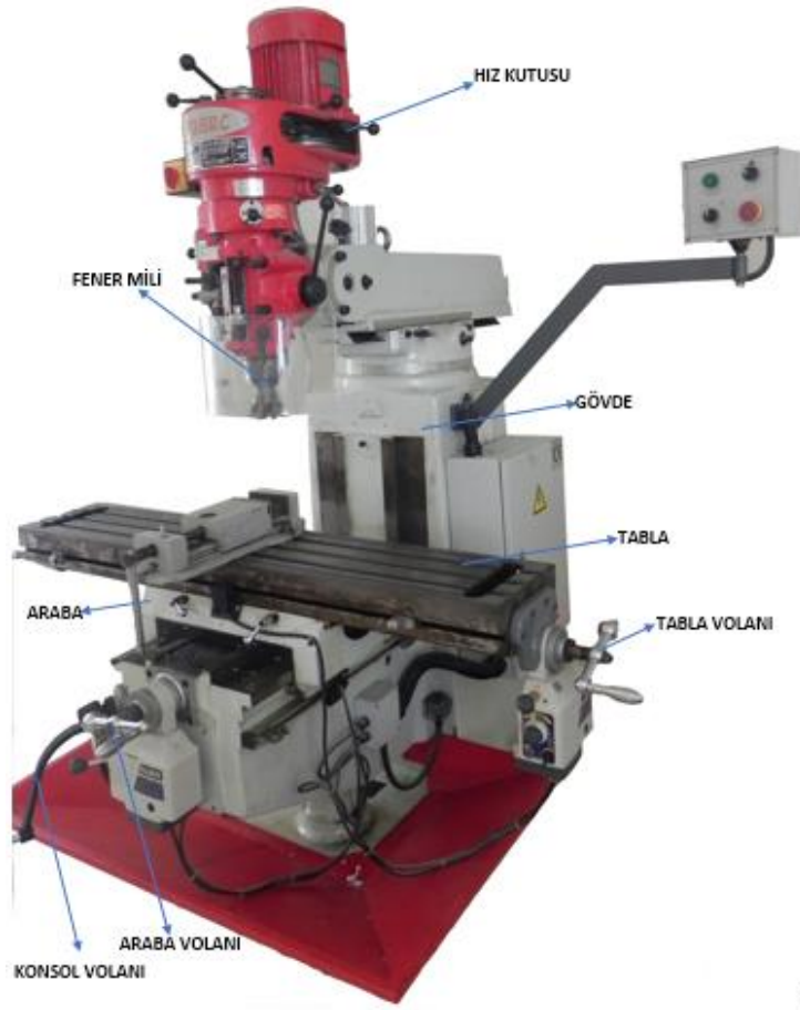
Şekil 1.4.1: Freze tezgâh kısımları
