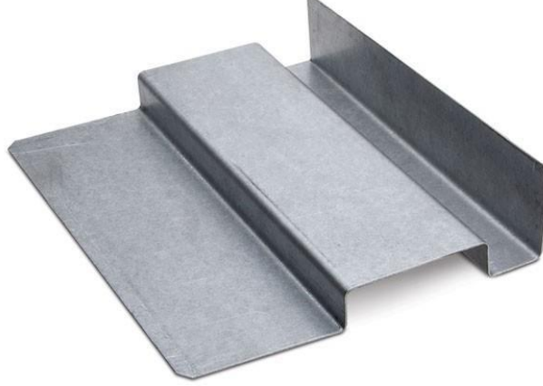
Şekil 1.2.19: Bükme işlemi uygulanmış sac malzeme
