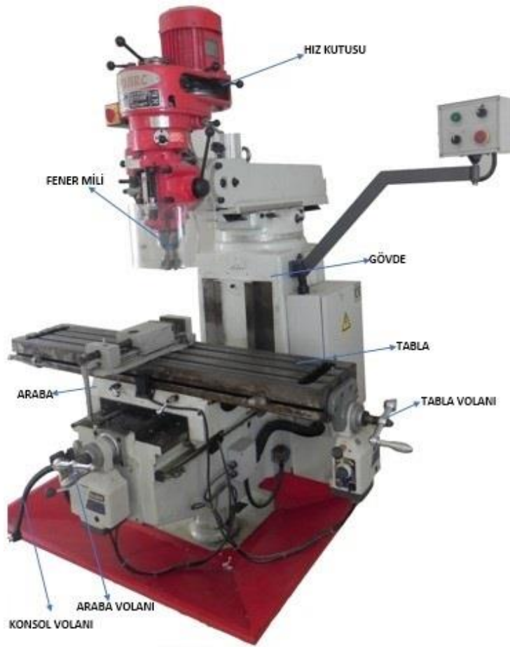
Şekil 1.4.1: Freze tezgâh kısımları
