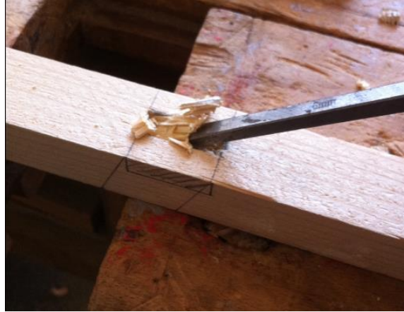
Resim 1.69: Payandanın tezgâha bağlanması ve iskarpela ile oyulması
