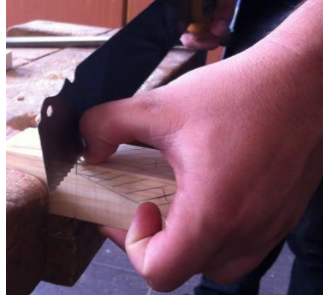
Resim 1.56: Çalışma tezgâhına bağlama ve enine dikey kesim testere izi belirleme
