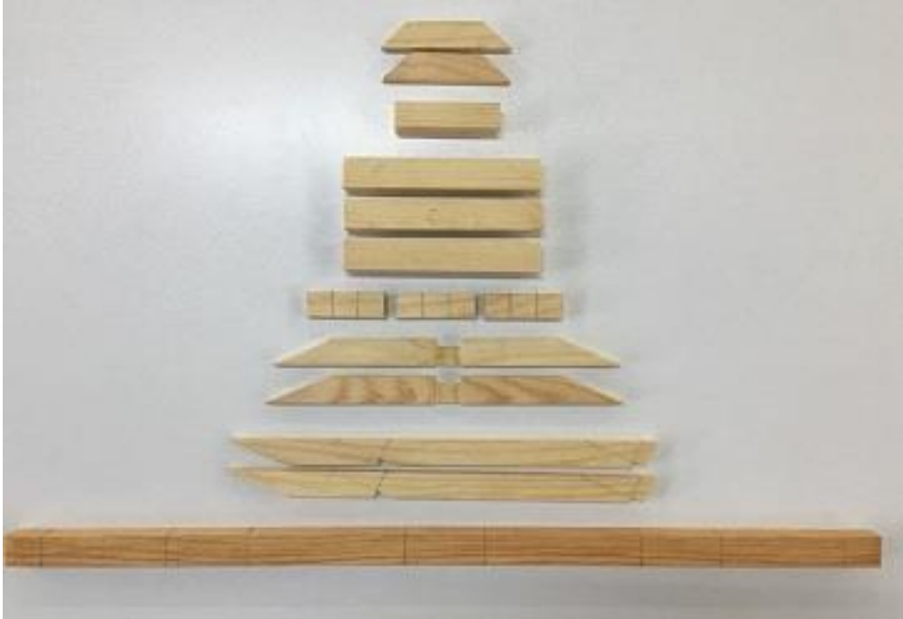
Resim 2.19: Montaja hazır ahşap tek dikmeli oturtma çatı makası elemanları
