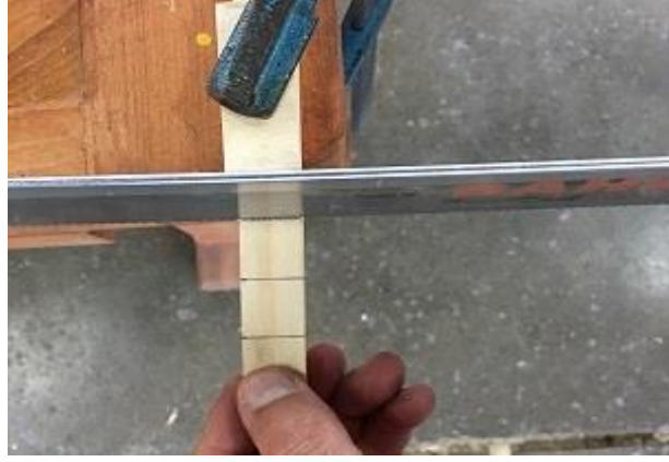
Resim 2.14: Yastık boylarının kesilmesi
