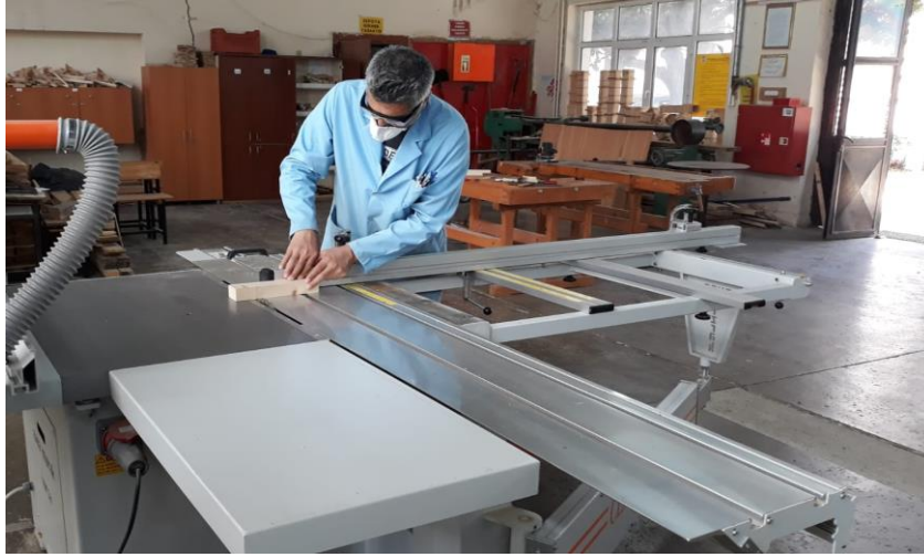
Resim 1.11: Daire testere makinesinde parça kesim gösterimi
