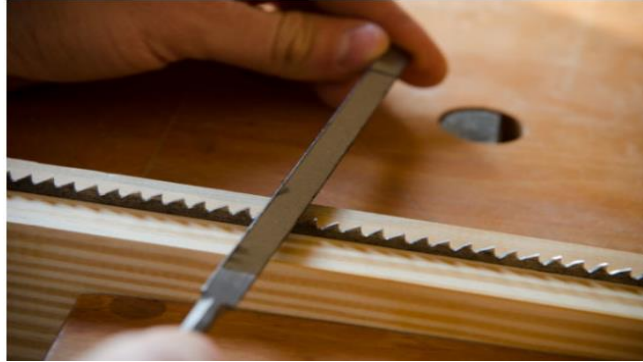
Resim 1.27: Testere dişlerinin eğelenmesi
