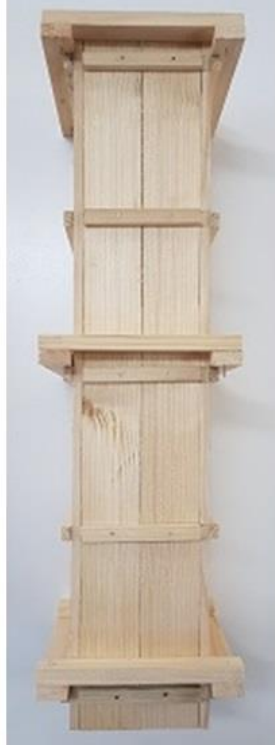
Resim 3.18: Montajı tamamlanmış ahşap dikdörtgen kesitli kolon kalıbı
