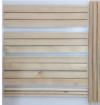
Resim 3.3: Ahşap dikdörtgen kesitli kolon kalıp malzemeleri
