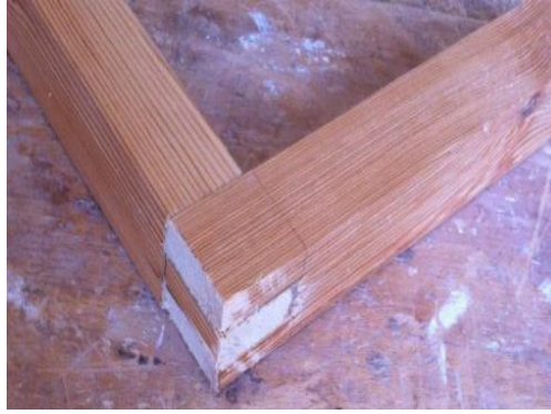
Resim 1.65: Zıvanalı geçme birleştirme ve düzgünlük kontrolü
