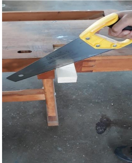
Resim 1.38: Mengene ile sabitlenen ahşap parçaya testerenin yerleştirilmesi
