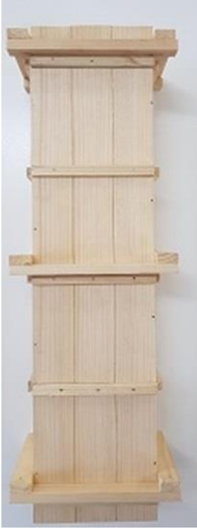
Resim 3.18: Montajı tamamlanmış ahşap dikdörtgen kesitli kolon kalıbı
