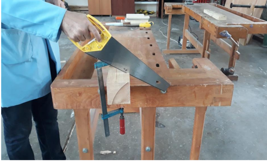
Resim 1.39: Testerenin ahşap temrin parçası ile yaptığı 45^{\circ} açıda kesimi
