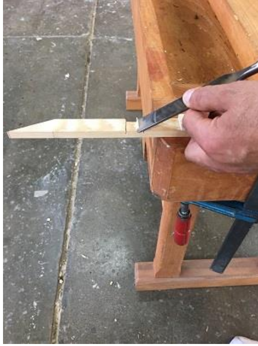
Resim 2.18: Kuşaklardaki geçmelerin yapılması
