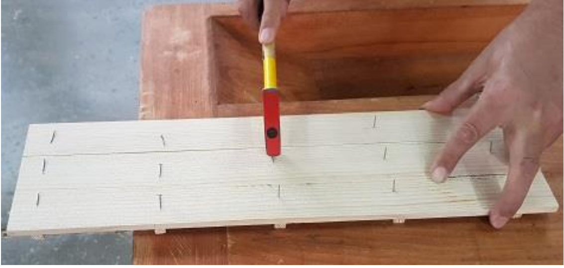
Resim 3.10: Klapa montajı (çivilerin eğilmesi)
