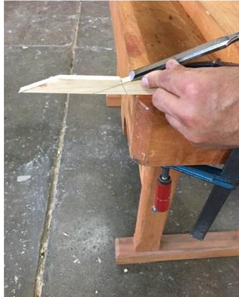
Resim 2.17: Merteklerdeki geçmelerin yapılması
